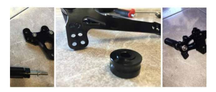
3. Installer le nouveau support biellette sur l'axe de sélection. Puis fixer la nouvelle platine au cadre à l'aide des vis d'origine
