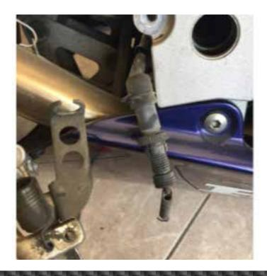
3. Visser la nouvelle pièce de jonction du MC avec la nouvelle pédale. (Attention, le méplat doit être côté écrou)
