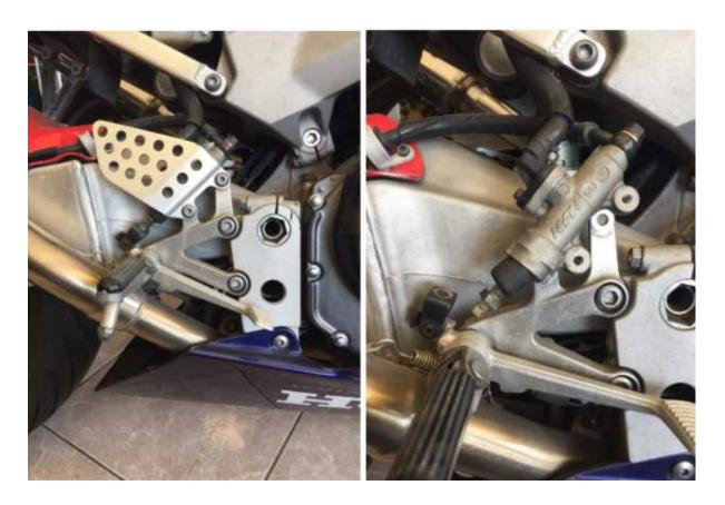
2. Dévisser les vis de fixation de la platine d'origine sur le cadre et désolidariser le contacteur de frein de la platine.
