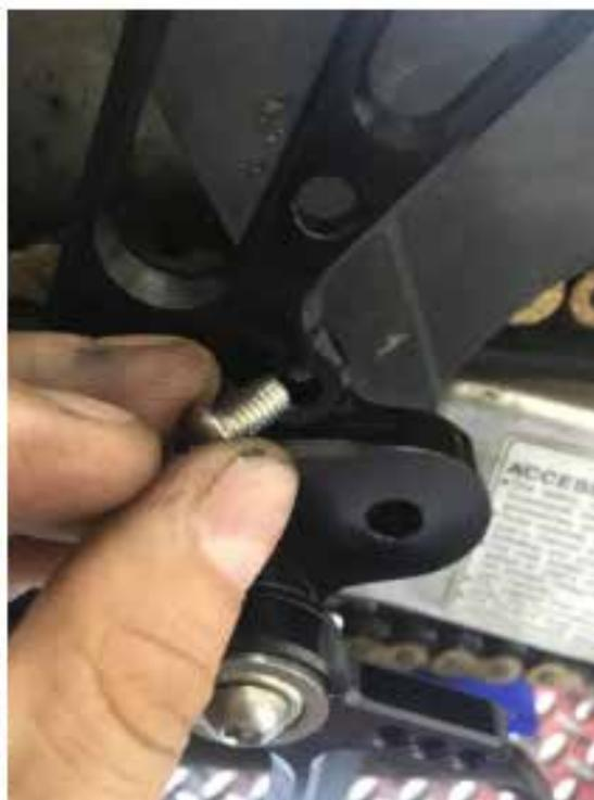
**3.** Montare il perno con il distanziale in dotazione. (Attenzione, il bordo del distanziale deve essere sul lato della rotazione)
