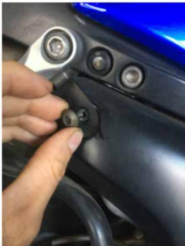
**2.** Rimuovere le viti di fissaggio del cilindro maestro. E smontare la piastra svitando le viti che si fissano al telaio.
