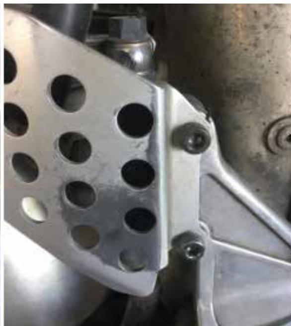
**3.** Fissare la piastra dalla parte posteriore tramite le viti fornite. E fissare la piastra principale sul telaio tramite la vite d'origine
