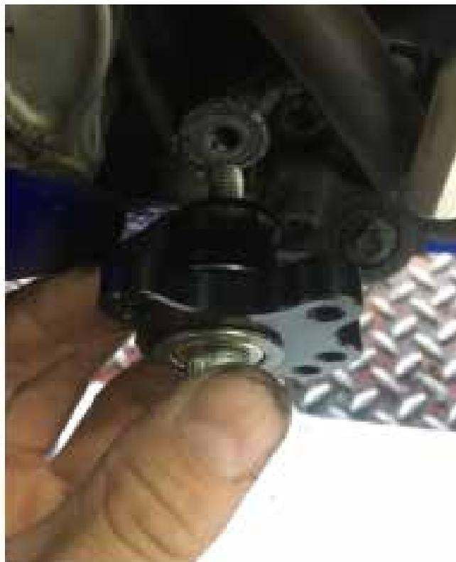
**4.** Fissare il nuovo giunto a sfera sull'asta del selettore originale
