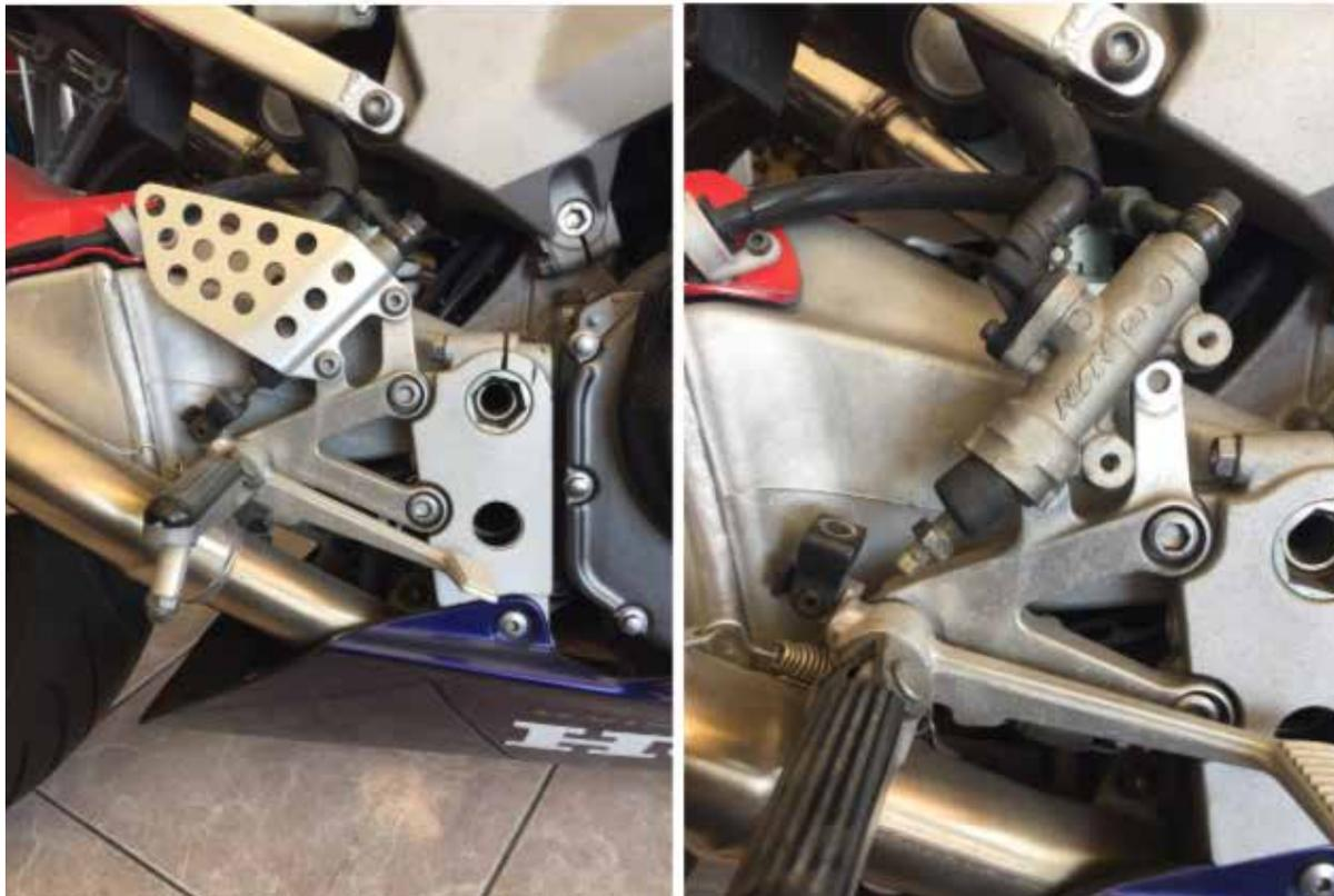
**2.** Svitare le viti di fissaggio della staffa originale sul telaio e sganciarle l'interruttore del freno dalla piastra.
