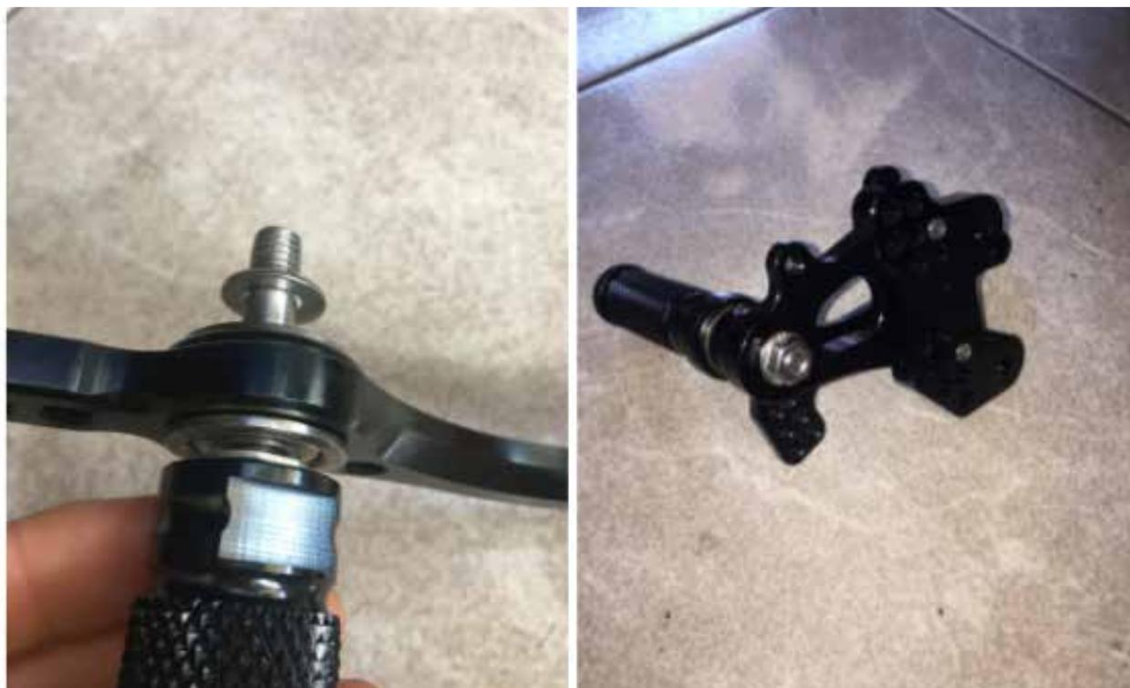
**5.** Fissare la nuova piastra al telaio utilizzando le viti originali. Fissare l'insieme del cilindro maestro e paratacco al telaio utilizzando le viti fornite. Quindi fissare la pompa freno al pedale utilizzando la rondella e clip.
