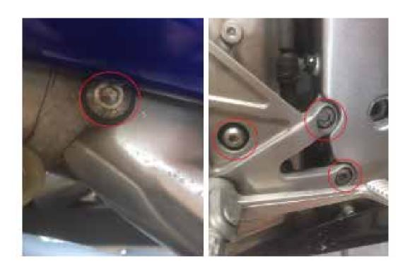
3. Installazione della piastra di regolazione sul telaio utilizzando le viti originali e la piastra supporto pedana utilizzando le viti in dotazione (Si ricorda che le rondelle devono essere installate con il bordo arrotondato verso il cuscinetto)
