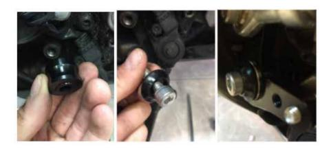
3. Sull'asta in dotazione, installare i 2 rimanenti giunti sferici e fissare questa asta sul cambio e sulla pallina (pallina lato cambio ). E l'asta originale sulla parte "della pallina".
