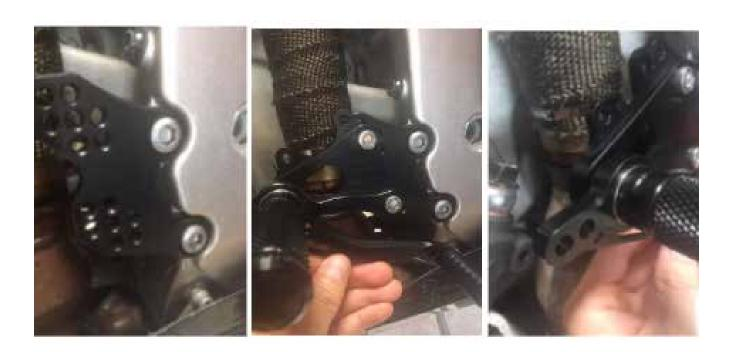
**4.** Rimontare la pompa freno utilizzando le viti in dotazione. L'altezza del pedale viene regolata tramite il dado / controdado sul giunto sferico della pompa freno.
