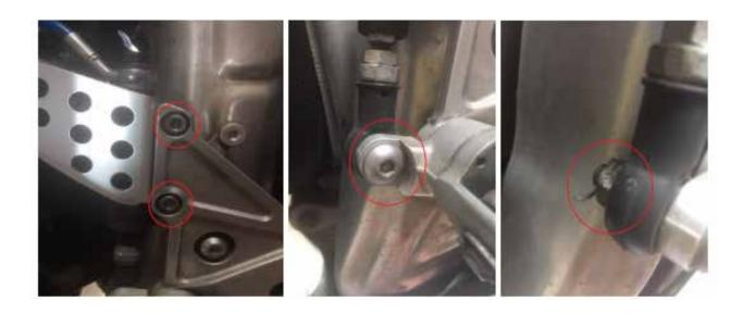
2. Rimuovere le viti dal paracalore e fissare la piastra al telaio. Si consiglia di mettere una banda di para calore o una volta rimossa la piastra originale.
