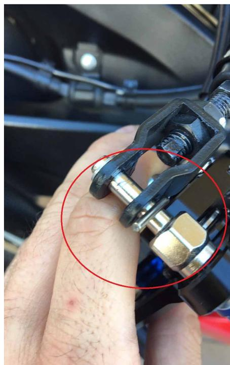
**3.** Befestigen Sie den Hauptzylinder wieder an der Platte, die Platte am Rahmen und den Fersenschutz mit den Distanzstücken.
