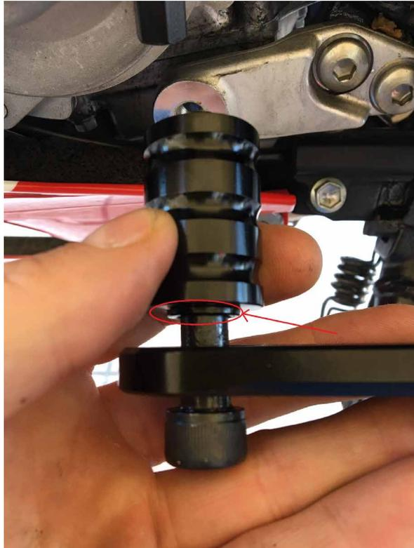
**4.** Schrauben Sie das neue Kugelgelenk in die Welle (Achtung: Verwenden Sie das Modell mit umgekehrter Steigung wie auf dem Bild) Befestigen Sie das Kugelgelenk mit der mitgelieferten Schraube und dem kleinen schwarzen Distanzstück zwischen Kugelgelenk und Schalthebel.
