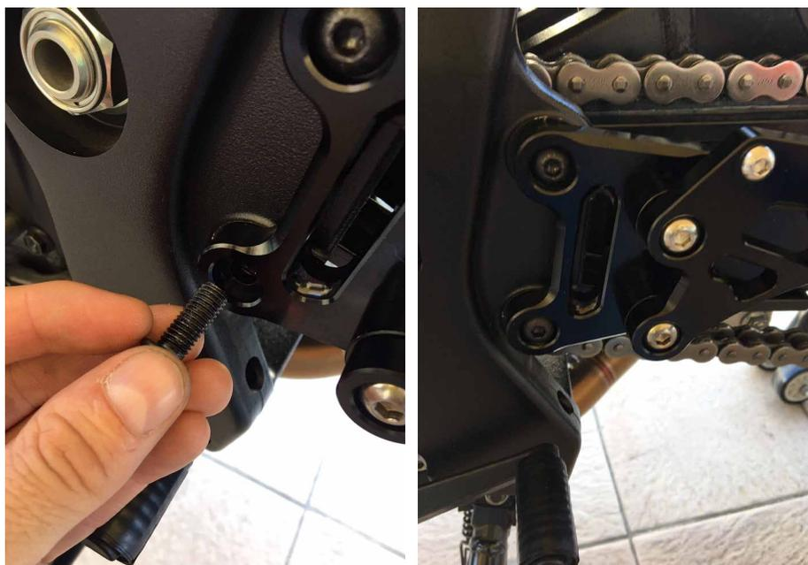
**3.** Befestigen Sie den neuen Hebel mit der großen BTR-Schraube an der Stelle des ursprünglichen Hebels und dem großen Distanzstück (legen Sie die Kante des Distanzstücks auf die Lagerseite)
