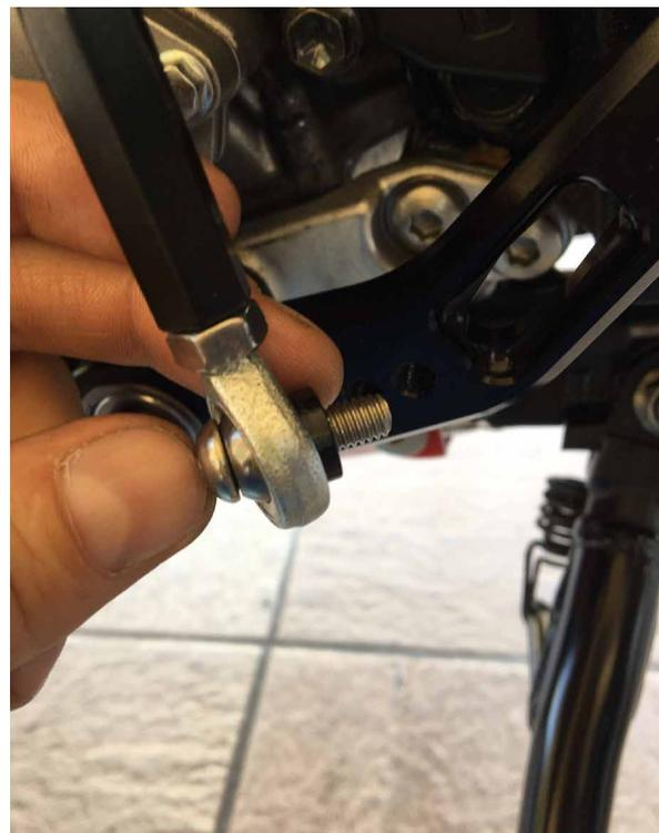
**5.** Achten Sie beim Einstellen der Höhe des Schalthebels darauf, dass die 2 Kugelgelenke gleichzeitig abgeschraubt werden
