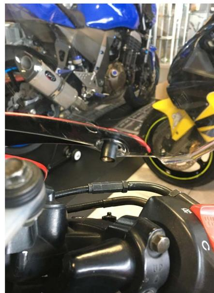
**4. Mettre les vis spéciales bulle et les visser. Les visser aura pour action de faire "gonfler" le caoutchouc des écrous noyés et de serrer la bulle.**
