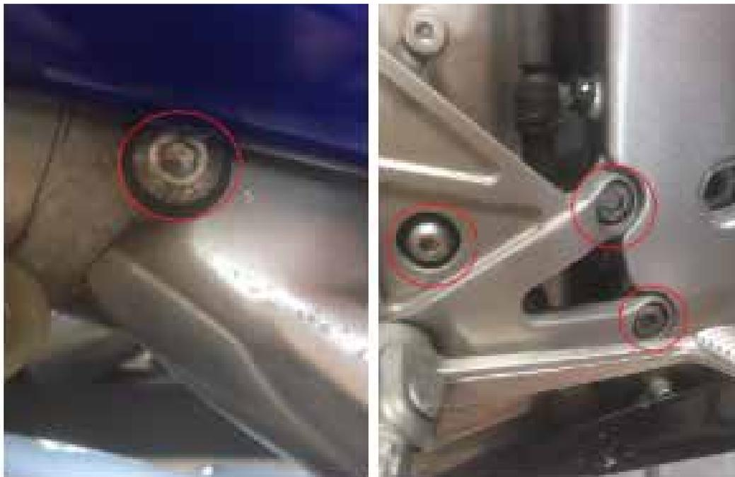
**3.** Montage der Justierplatte am Rahmen mit den Originalschrauben und der Fussauflageplatte mit den mitgelieferten Schrauben (Hinweis: die Unterlegscheiben müssen mit der abgerundeten Kante zum Lager hin montiert werden).
