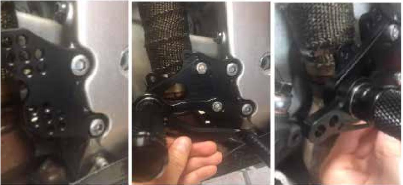
**4.** Bringen Sie den Hauptzylinder mit den mitgelieferten Schrauben wieder an. Die Einstellung der Pedalhöhe erfolgt mit Hilfe der Mutter/Kontermutter am Kugelgelenk des Hauptzylinders.
