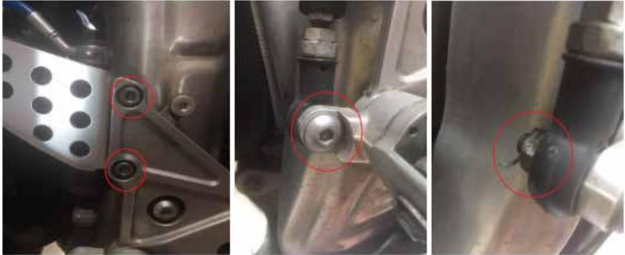
**2.** Entfernen Sie die Schrauben des Hitzeschilds und der Plattenbefestigung am Rahmen. Es ist ratsam, einen Hitzeschutzstreifen anzubringen, nachdem die Originalplatte entfernt wurde.
