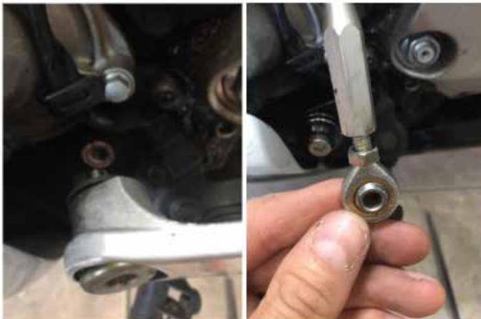
**2.** Befestigen Sie den "Pivot"-Teil an Stelle des ursprünglichen Schalters (kleiner Flansch auf der Lagerseite)
