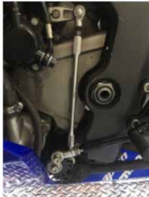
MONTAJE DEL CAMBIO DE MARCHA INVERTIDO (1 era hacia abajo)
