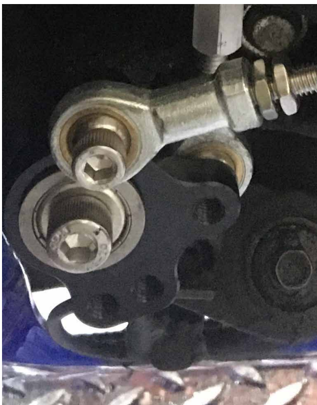
MONTAJE DEL CAMBIO DE MARCHA (1 era marcha abajo)
