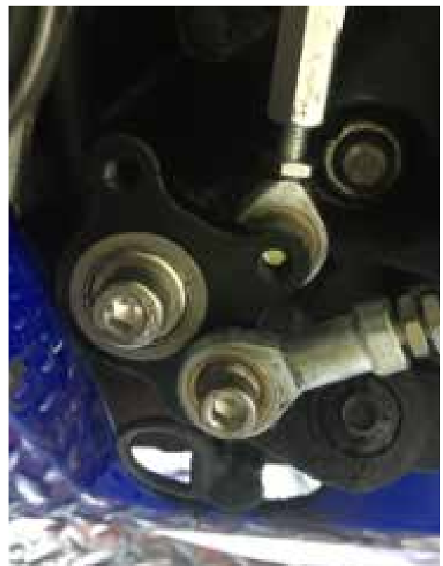
MONTAJE DEL CAMBIO DE MARCHA INVERTIDO (1 era hacia abajo)
