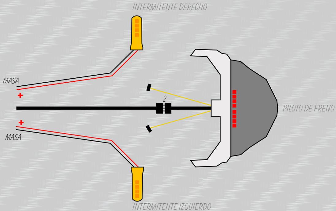
**4. EL MONTAJE DE LAS RESISTENCIAS (NO ES NECESARIO SI LA VELOCIDAD DE LOS INTERMITENTES ESTA NORMAL DESPUES DE LA INSTALACION)**
