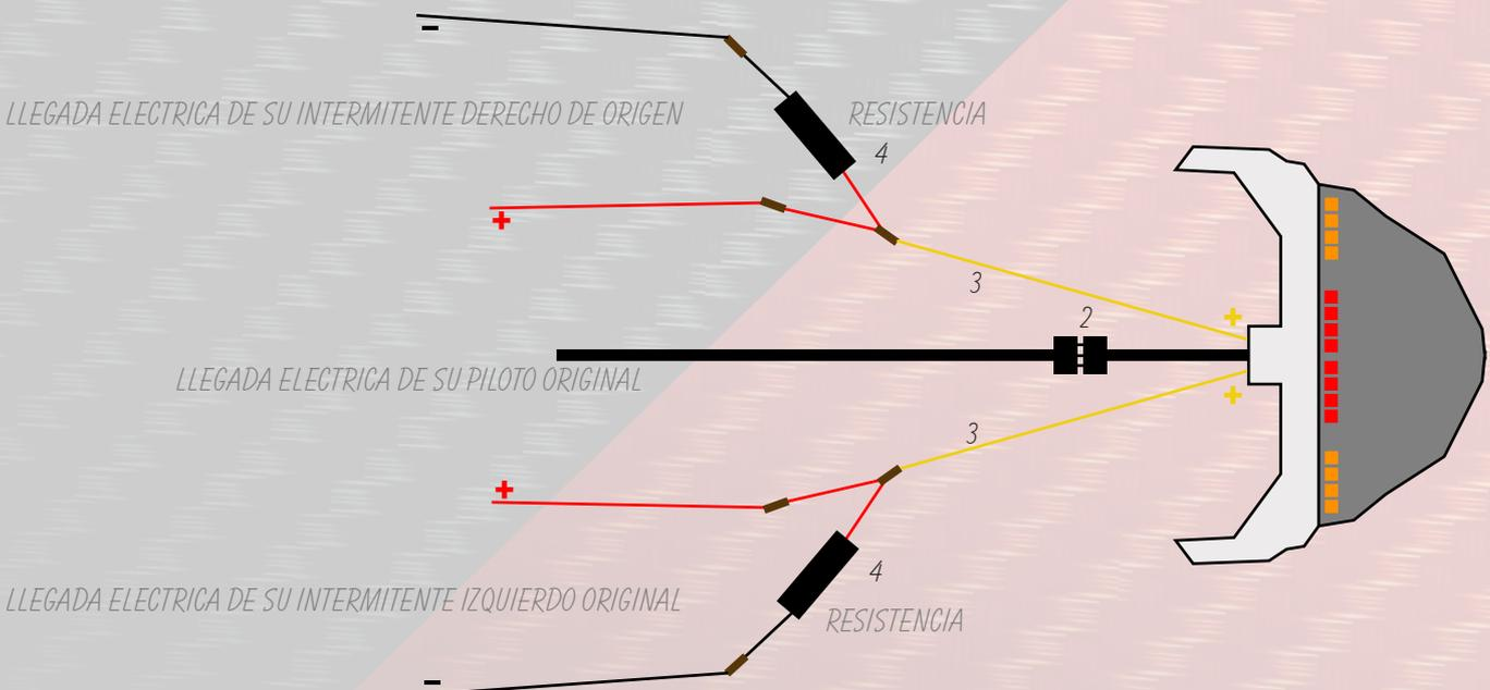
**NB: Si una vez conectadas las resistencias no reducen el parpadeo, o si error en ODB, significa que se necesita cambiar la central intermitente original por una con intermitentes con LED!**
