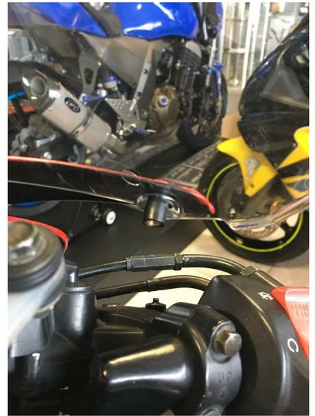
**4.** Die speziellen Windschildschrauben einsetzen und einschrauben. Wenn man sie einschraubt, "bläht" sich der Gummi der eingebetteten Muttern auf und zieht die Blase fest.
