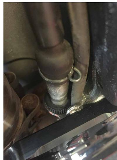
**Il est impératif de fixer la durite de bocal de frein à la durite de frein partant du MC à l'aide du collier nylon de manière à ce que la durite ne vienne pas en contact avec le tube d'échappement**
