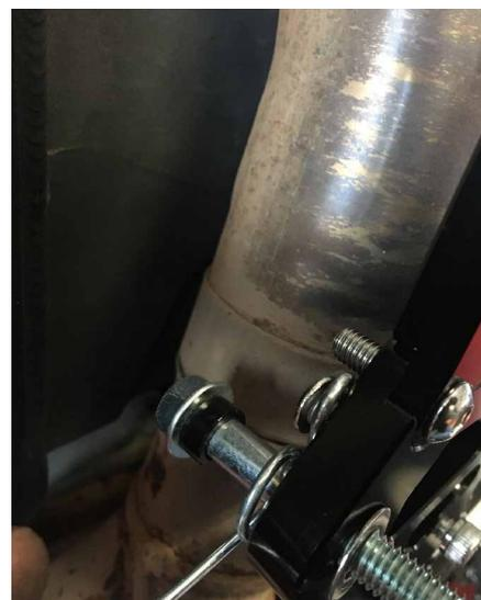
**6.** Installer le repose-pied en prenant soin de mettre la rondelle conique noire entre le repose-pied et le roulement. Installer l'embout de pédale et le contacteur de frein à son emplacement prévu.
