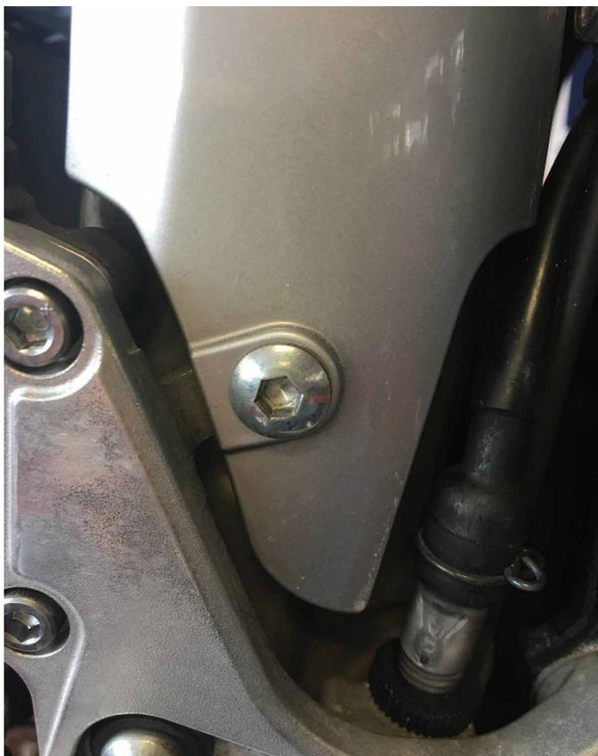
**2.** Désolidariser la platine du maître-cylindre de frein arrière en dévissant l'ensemble vis écrou tenant la pédale au MC (attention, il y a une goupille fendue), en dévissant les 2 vis BTR tenant le protège-talon et en dévissant la vis de fixation de la protection alu (2 vis BTR)
