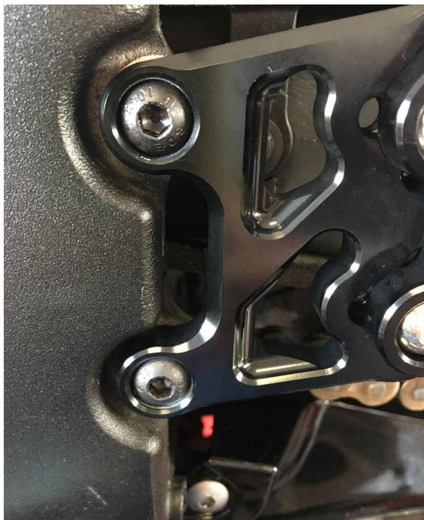
**3.** Dévisser la vis fixant la durite de liquide de refroidissement en acier et celle fixant le carter protégé pignon de sortie de boîte, puis fixer le support du pivot à l'aide des vis fournies (attention le collier tenant le câble du contacteur de béquille doit rester entre le support et le carter de PS). Fixer le pivot à l'aide de la longue entretoise et de la vis BTR fournie.
