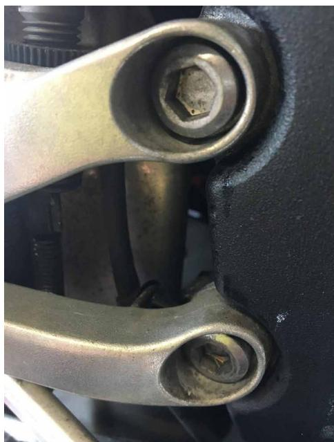
**4.** Installer la nouvelle platine à l'aide des vis BTR fournies
