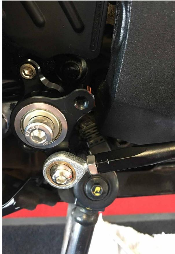
**4.** Fixer la longue tige avec les rotules fournies sur le sélecteur et le pivot, et la courte sur le pivot et la rotule d'origine restée sur la moto
