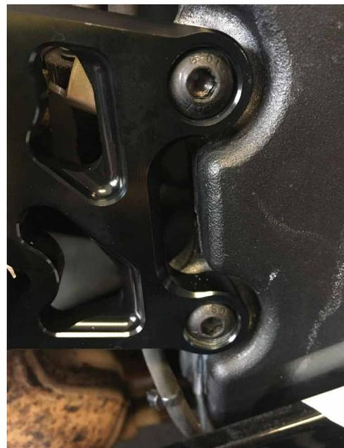
**5.** Befestigen Sie den Hauptzylinder mit den 2 BTR-Schrauben, die für den oberen Teil vorgesehen sind. und der Stift und der Clip auf dem Kugelteil (Positionieren Sie die Feder so, dass das Bremspedal zurückkehren kann). Beim Einbau des Bremspedals ist darauf zu achten, dass die Unterlegscheibe zwischen der Platte und dem Lager richtig positioniert ist, d.h. die abgerundete Kante auf der Lagerseite.
