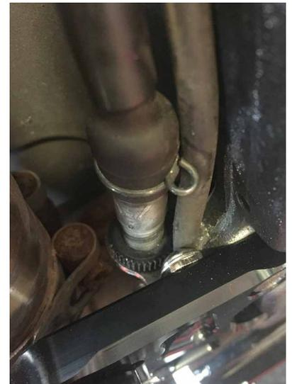
**Es ist unbedingt erforderlich, den Schlauch des Bremsgefäßes mit der Nylonmanschette am Bremsschlauch vom Hauptzylinder zu befestigen, damit der Schlauch nicht mit dem Auspuffrohr in Berührung kommt.**
