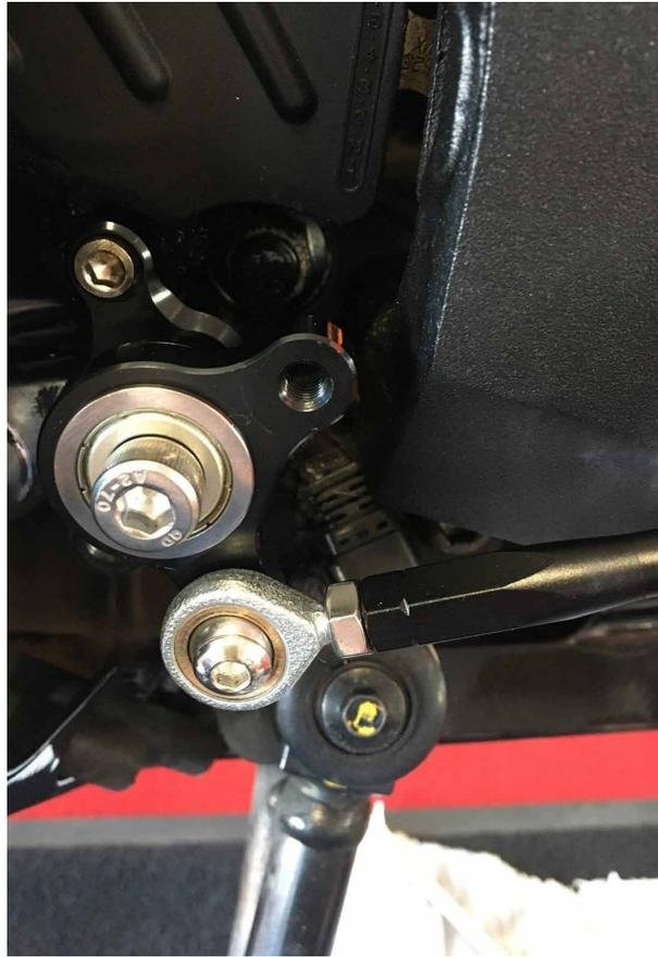
**4.** Befestigen Sie die lange Stange mit den mitgelieferten Kugelgelenken am Schalthebel und am Schwenkgelenk, die kurze Stange am Schwenkgelenk und das ursprüngliche Kugelgelenk, das am Motorrad verbleibt.
