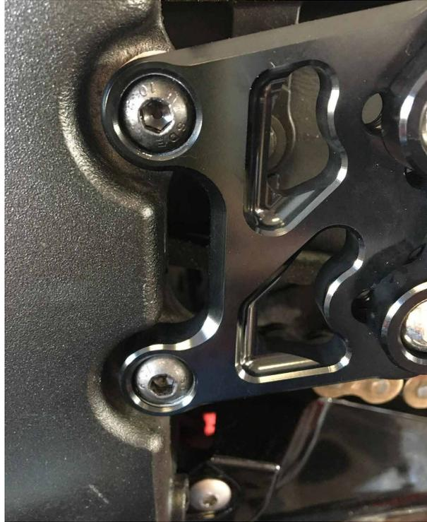
**3.** Lösen Sie die Schraube, mit der der Stahl-Kühlmittelschlauch befestigt ist, und die Schraube, mit der die Abdeckung des Getriebeausgangsritzels befestigt ist, und befestigen Sie dann die Schwenkhalterung mit den mitgelieferten Schrauben (beachten Sie, dass die Manschette, die das Standschalterkabel hält, zwischen der Halterung und dem Getriebeausgangsritzels verbleiben muss). Befestigen Sie den Schwenkhalterung mit dem langen Distanzstück und der mitgelieferten BTR-Schraube.
