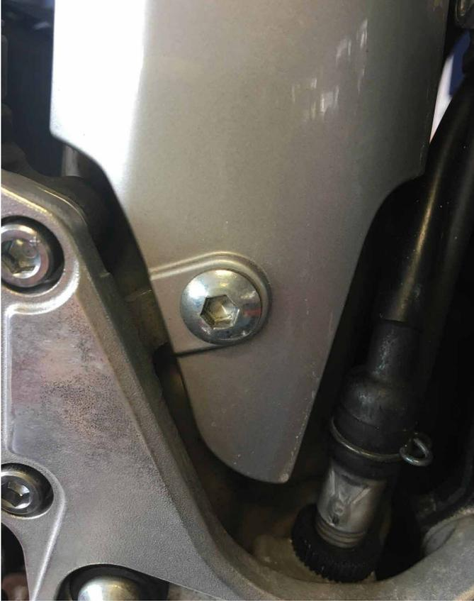
**2.** Entfernen Sie die Platte vom hinteren Hauptbremszylinder, indem Sie die Schraube und Mutter abschrauben, die das Pedal am Hauptzylinder hält, (Vorsicht, es gibt einen Splint), die 2 BTR-Schrauben, die den Fersenschutz halten, und die Befestigungsschraube des Aluminiumschutzes lösen. (2 BTR-Schrauben)
