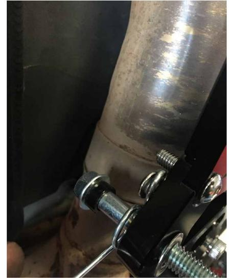
**6.** Installieren Sie die Fußstütze, wobei darauf zu achten ist, dass die schwarze konische Unterlegscheibe zwischen Fußstütze und Lager platziert wird. Installieren Sie die Pedalspitze und den Bremsschalter an der vorgesehenen Stelle.
