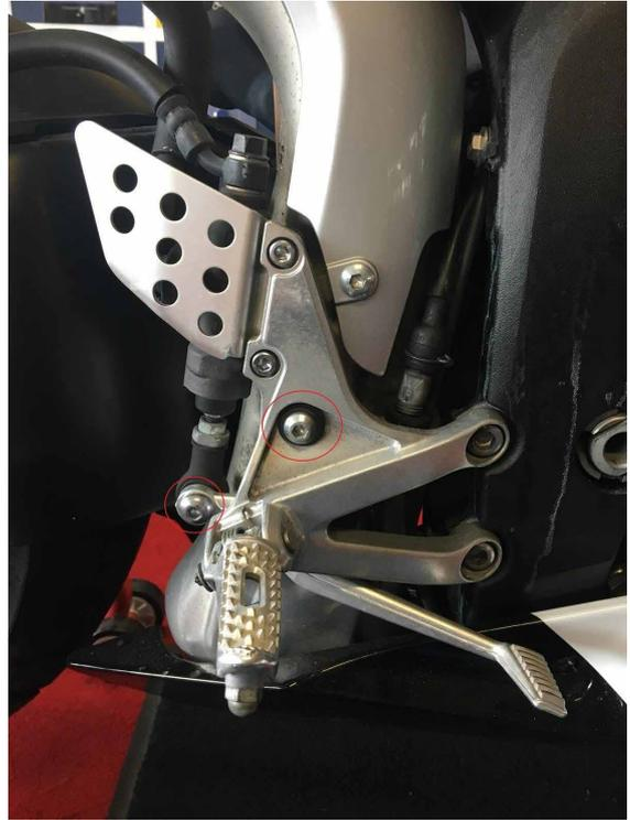
**3.** Die Platte durch Lösen der 2 BTR-Schrauben vom Rahmen entfernen.
