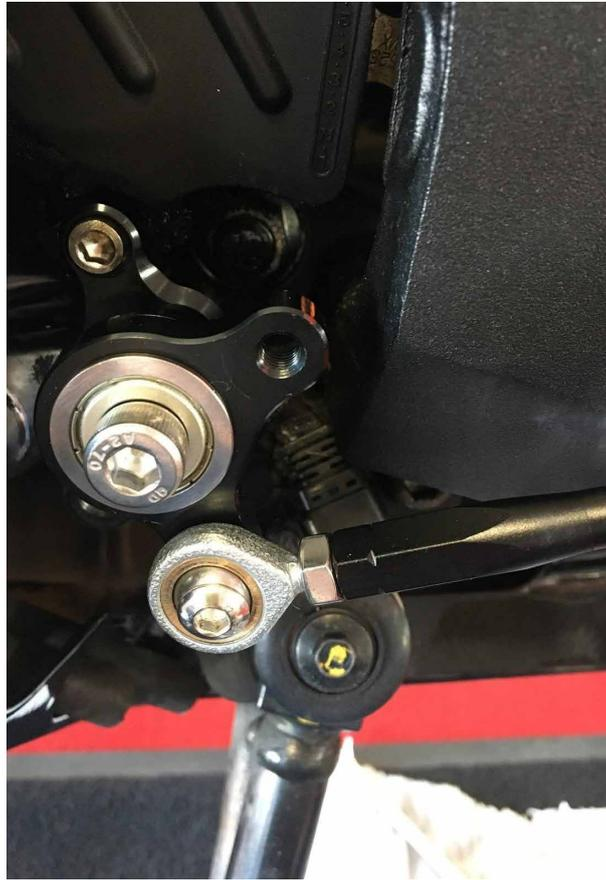
**4.** Fissare l'asta lunga con i giunti sferici in dotazione sul cambio e il perno, e quella corta sul perno e lo snodo sferico originale rimasti sulla moto.
