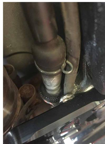
**È imperativo fissare il tubo del serbatoio del freno al tubo del freno dal cilindro maestro utilizzando la fascetta in nylon in modo che il tubo non vada a contatto con il tubo di scarico**
