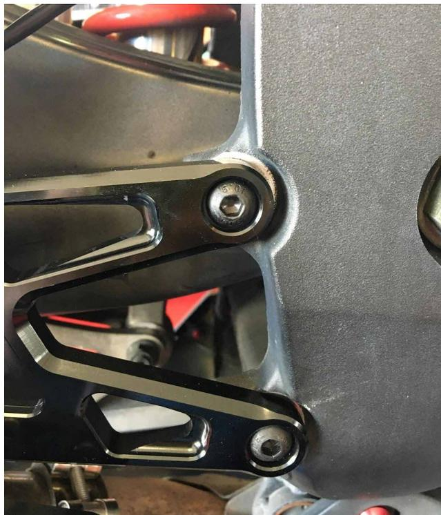
**3.** Den Hauptzylinder mit den BTR-Schrauben und Muttern an der Platte befestigen und mit dem mitgelieferten Stift und dem Clip am Pedal sichern. Achten Sie beim Einbau der Bremspedal-/Fußraste darauf, dass sich die Unterlegscheibe in der richtigen Position befindet. zwischen der Platte und dem Pedal mit der abgerundeten Kante auf der Lagerseite
