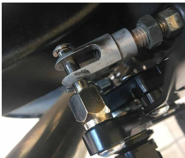
**4.** Rückholfeder und Bremsschalter installieren (Verwenden Sie ggf. die für den Schalter mitgelieferte Feder und stellen Sie diese auf die richtige Länge für Ihr Motorrad ein).
