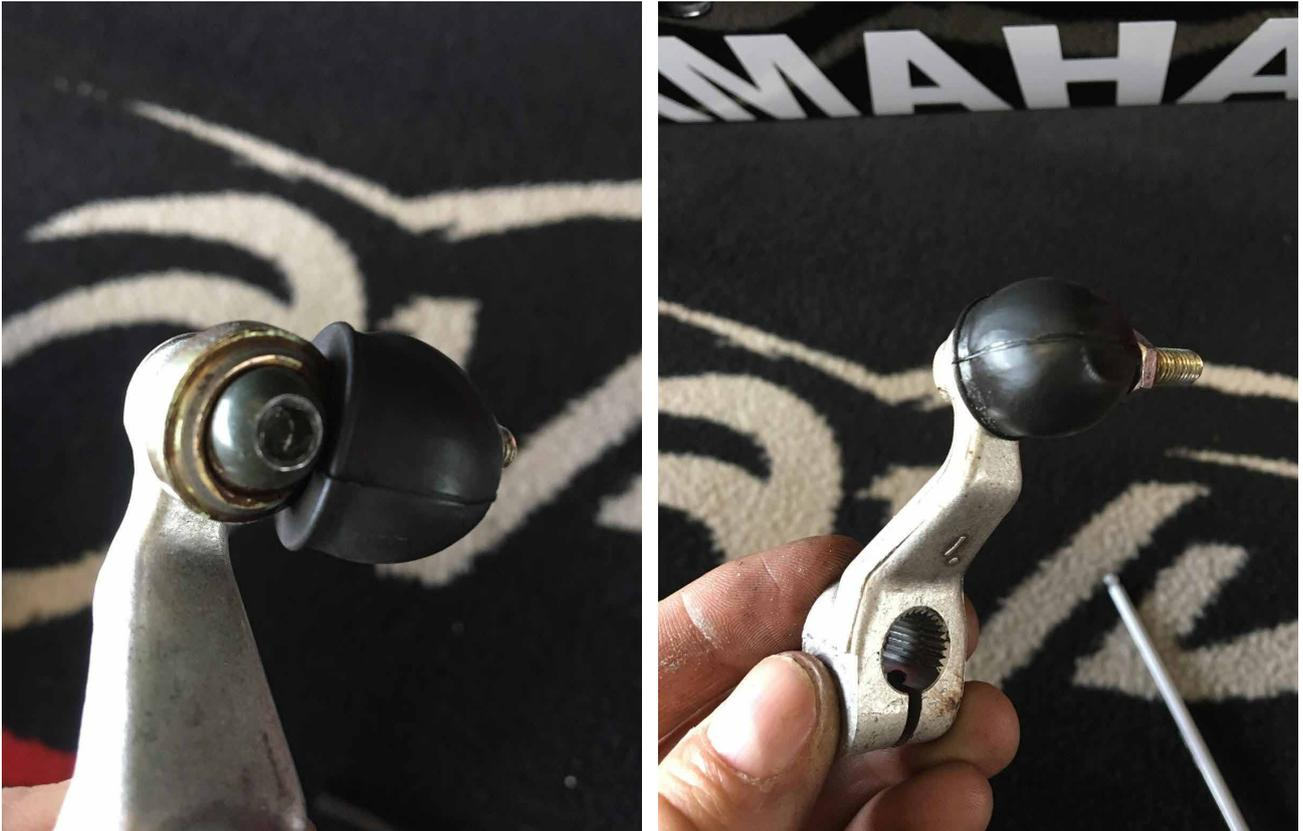
**5.** Positionieren Sie die Schaltstange und den Schaltstift so, dass die Stange und der Schaltstift einen Winkel bilden, der so nahe wie möglich bei 90° liegt.
