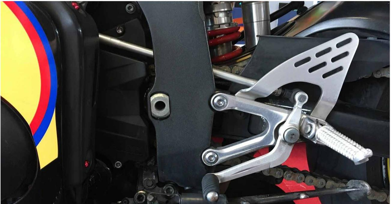
Es ist möglich, diese Anlage in "umgekehrter Richtung" (1. oben) zu setzen, indem man die Verbindungsstange auf der Schaltwelle um 180° dreht, aber es wird notwendig sein, den Ausgleichsbehälter zu versetzen.
