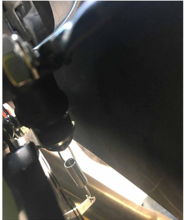
**5.** Installieren Sie die Pedalendkappe und den Exzenteranschlag
