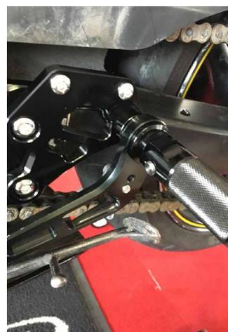
**4.** Entfernen Sie das ursprüngliche Kugelgelenk an der Verbindung der Schaltwelle und bringen Sie es auf der anderen Seite wieder an.
