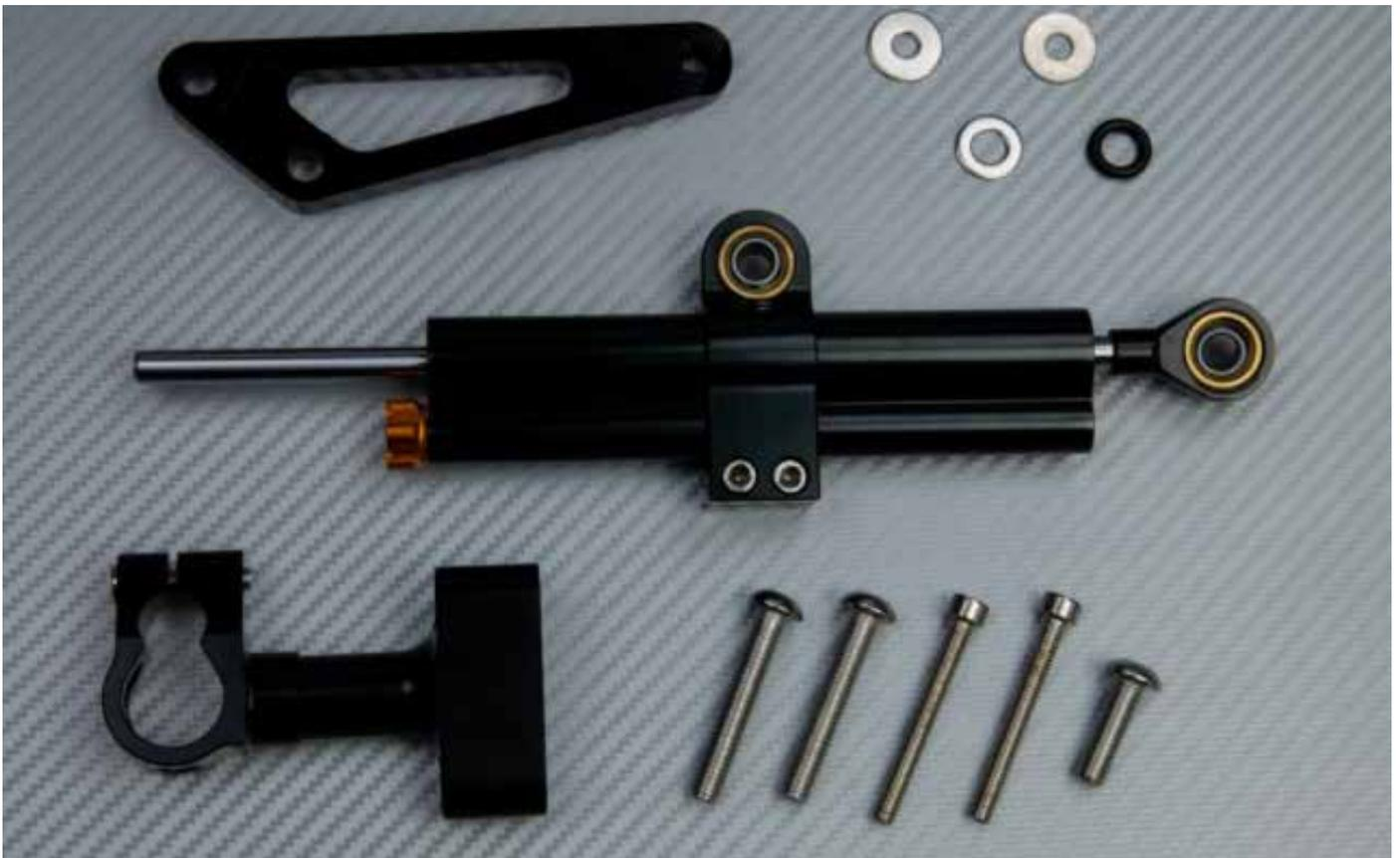
**1.** Desmontar los 2 tornillos de las torretas del manillar izquierdo e instalar la pata triangular con los tornillos M8 suministrados. El punto marcado en la torreta debe estar siempre orientada hacia la parte delantera de la moto.
