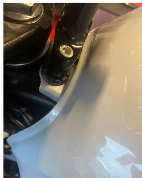
**3.** Instalar el collar de fijación del amortiguador utilizando el tornillo M6 cabeza abombada y las 2 pequeñas arandelas en diámetro 6mm.
