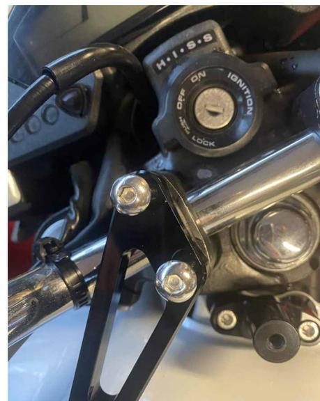
**2.** Desenroscar los 2 tornillos de fijación delanteros del depósito. Instalar la pieza en forma de "T" con los tornillos BTR M6 largos suministrados.
