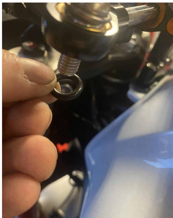
**5.** *Ajustar el cuerpo del cilindro en el collar antes de apretarlo para controlar que el amortiguador, al girar a la derecha y a la izquierda, no golpee ni el deposito ni la plata de fijación triangular.*
