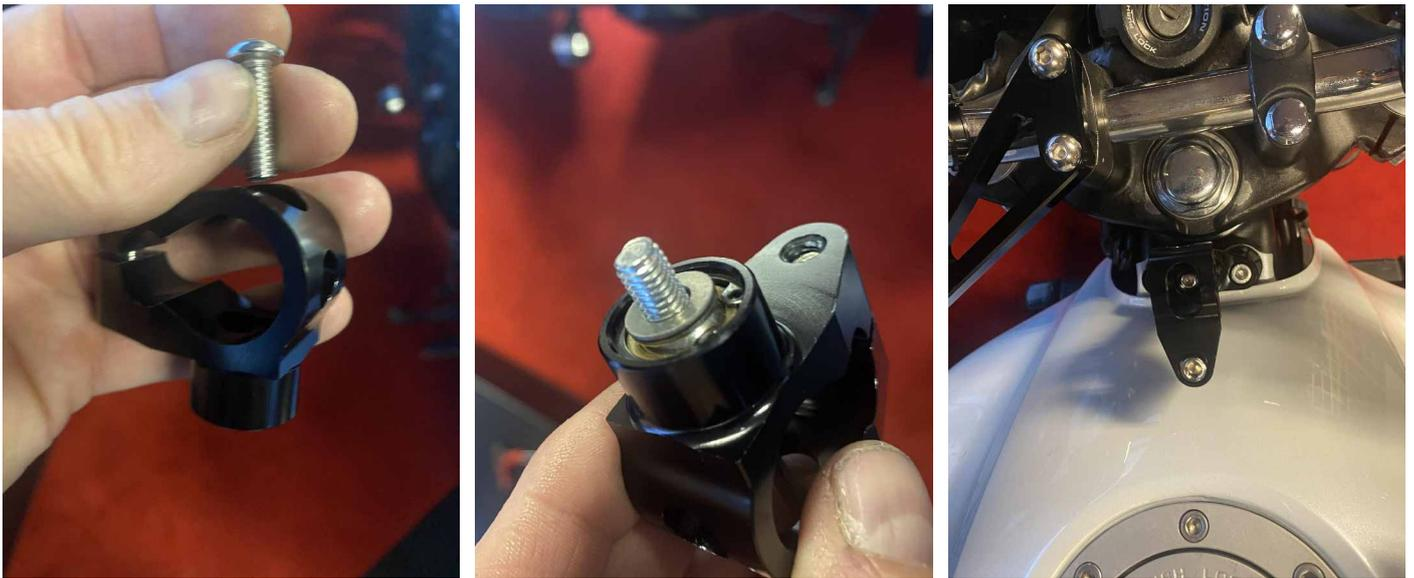
**4.** Schieben Sie den Stoßdämpfer in den Ring und befestigen Sie ihn am Dreiecksbügel mit Hilfe der M8 Schrauben, der Unterlegscheiben mit 8 mm Durchmesser und den beiden O-Ringe. Installieren Sie 1 O-Ring auf jeder Seite des Kugelgelenks.
