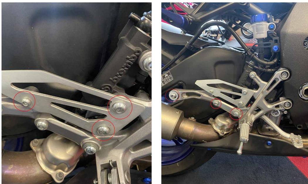
**2.** *Desenroscar los tornillos del maestro-cilindro del freno trasero*
