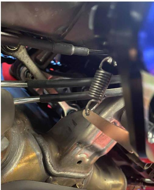
**6. Fijar el conjunto platino a la moto y fijar el cilindro maestro a la platina con los tornillos suministrados y separados/ tuercas.**
