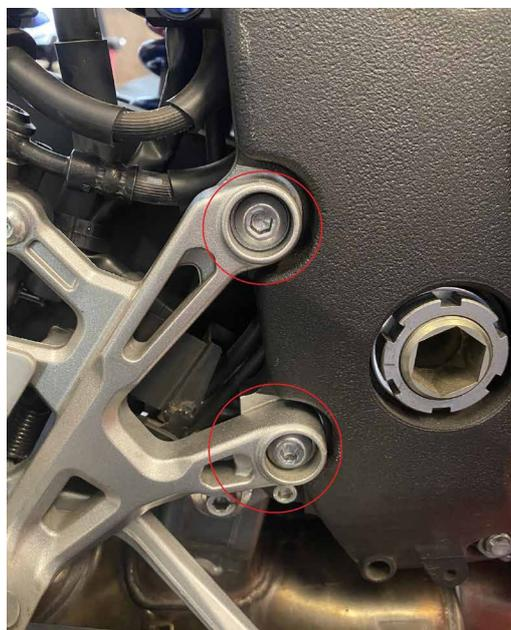
**3.** *Démonter le petit étrier du maître-cylindre et ré-installer notre rotule à la place.*
