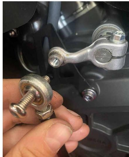
**4.** *Installer le nouvel embout de sélecteur, le repose-pied et le protège-talon.*
