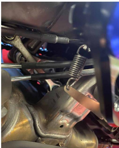
**6.** Fixer l'ensemble platine sur la moto et fixer le maître-cylindre à la platine à l'aide des vis fournies et des entretoises
