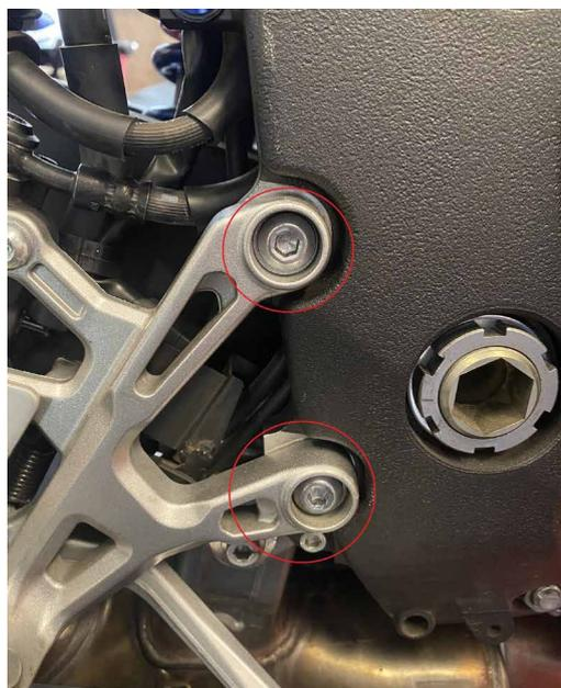
**3.** *Rimuovere la piccola staffa dal cilindro principale e reinstallare invece il nostro giunto sferico*
