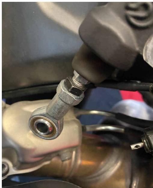
**4.** *Installare il poggiapiedi, il pedale del freno e fissare il giunto sferico a quest'ultimo*
