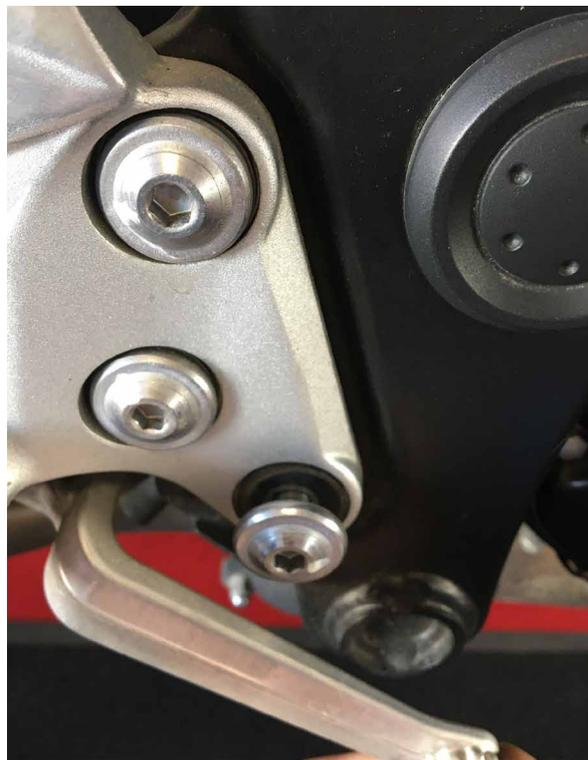
**3.** Montieren Sie die neue Platte mit den mitgelieferten Schrauben
