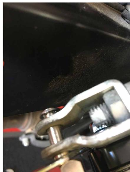
**6. Montieren Sie die Fußstütze, den Exzenter-Pedalanschlag und die Selektorkappe**
