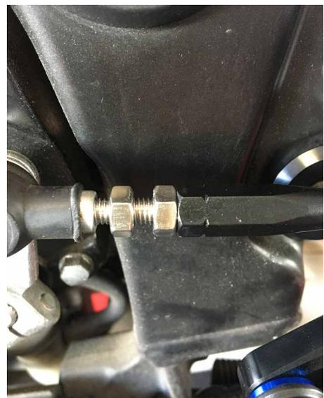
**7.** Befestigen Sie das Kugelgelenk der Wählstange am Wählschalter.
