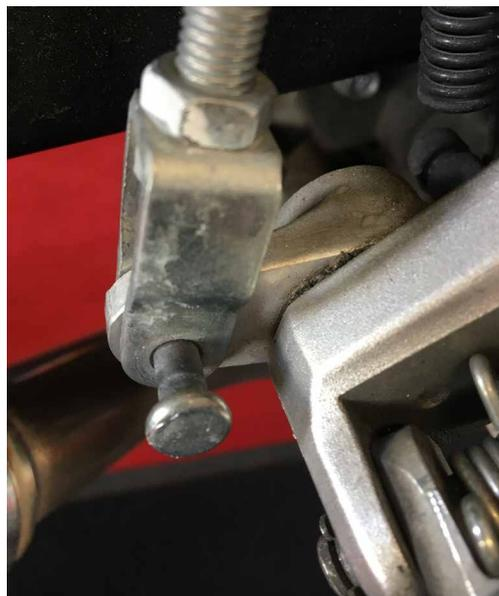
**2.** Trennen Sie den Hauptzylinder von der Platine. und demontieren Sie die Rahmenplatte
