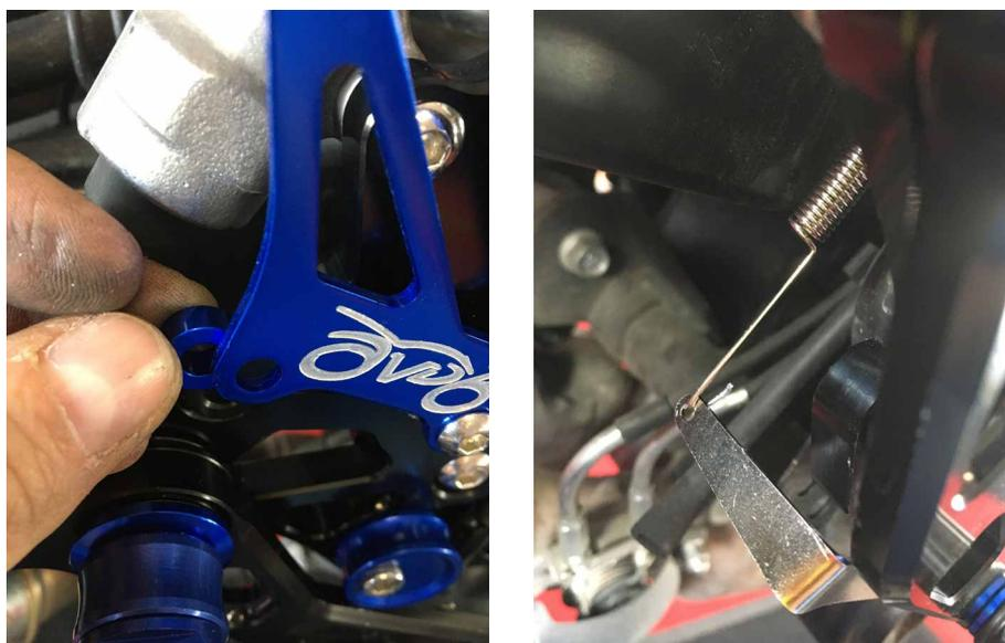
**8.** Fixer le bocal à l'aide de la patte en alu fournie, qu'il vous faudra mettre en forme en fonction de l'emplacement choisi (ici la vis de fixation du support de régulateur)
