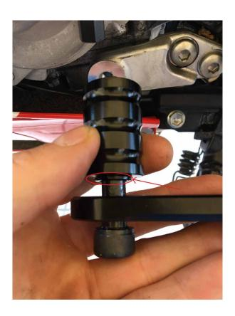
4. Visser la nouvelle rotule dans la tige. (Attention: utiliser le modèle avec pas inversé comme sur la photo). Fixer la rotule au sélecteur à l'aide de la vis fournie et de la petite entretoise noire, entre la rotule et le sélecteur
