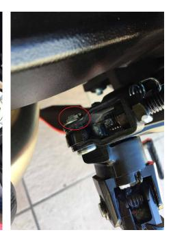
2. Fixer la nouvelle pédale au maître-cylindre à l'aide du nouvel axe fourni, de sa vis et du circlip. Mettre la tige du ressort en même temps (voir photo).
