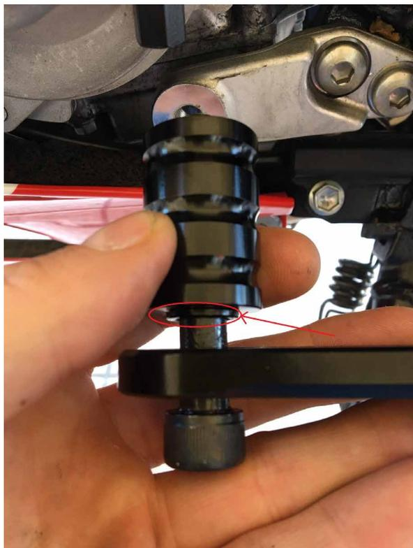
**4.** Avvitare il nuovo giunto sferico nell'asta. (Attenzione: utilizzare il modello con filettatura antioraria come in foto). Fissare il giunto sferico al cambio utilizzando la vite in dotazione e il piccolo distanziale nero, tra il giunto sferico e il cambio.
