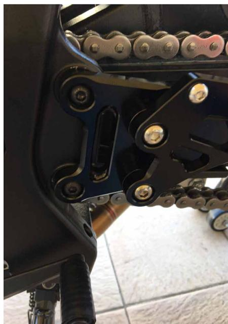
**3.** / Fissare il nuovo selettore al posto dell'originale utilizzando la vite grande BTR e il grande distanziale (posizionare il bordo del distanziale sul lato cuscinetto)
