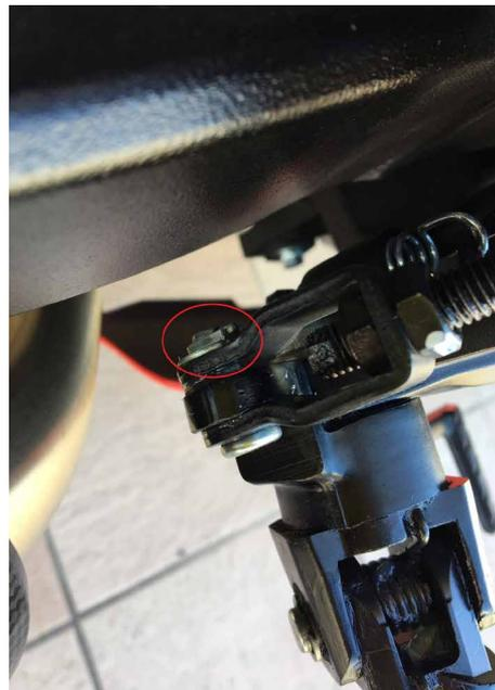
**2.** Fissare il nuovo pedale alla pompa freno utilizzando il nuovo perno in dotazione, la sua vite e l'anello. Metti contemporaneamente l'asta (vedi foto a lato)
