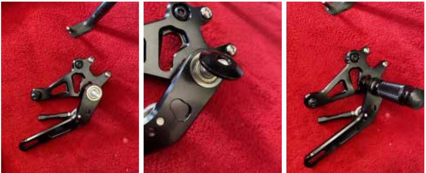
**3. Fixer la nouvelle platine sur le cadre et visser la nouvelle tige sur celle d'origine**
