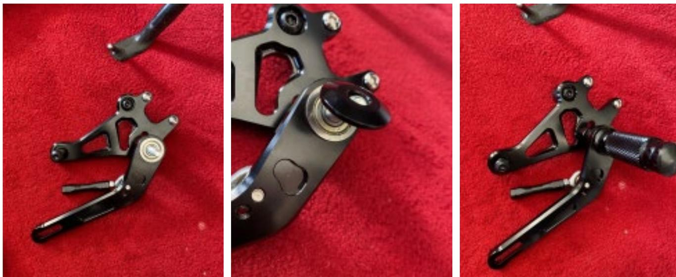
**3.** *Fissare la nuova piastra sul telaio e avvitare la nuova asta su quella originale
