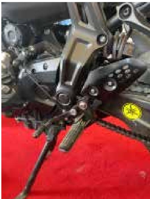
**2.** Montieren Sie die neue Platte und achten Sie dabei darauf, dass das große Distanzstück hinter dem Selektor mit der Kante auf der Lagerseite positioniert wird
