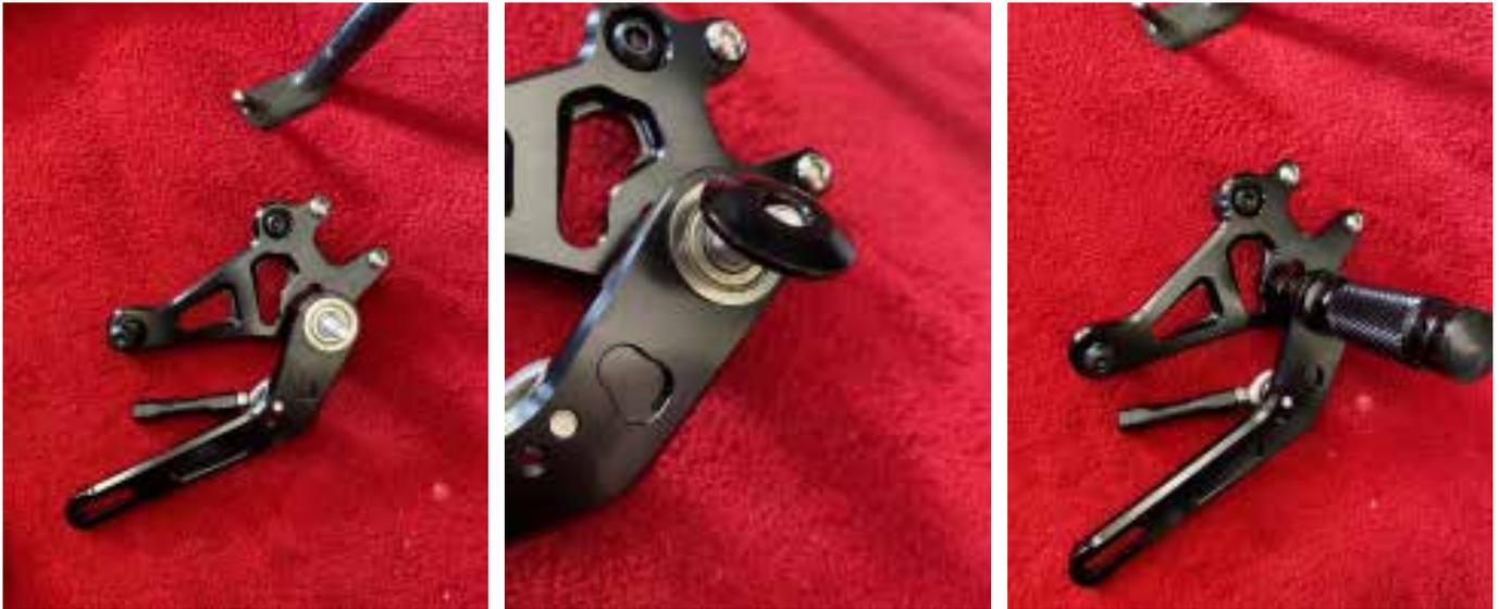
**3.** Befestigen Sie die neue Platte am Rahmen und schrauben Sie die neue Stange auf die originale. (Achten Sie darauf, dass Sie genug anschrauben, damit sich die Stängel) nicht ablösen.
