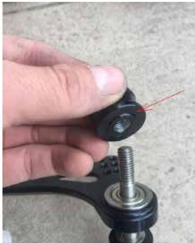
**4.** Dopo aver fissato la parte scanalata sull'albero del cambio, fissare l'asta del selettore (corta) Lato selettore, utilizzare il distanziale in dotazione.
