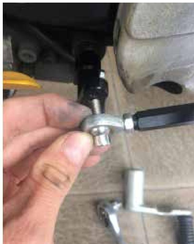
**5.** *Installare la protezione per il tallone utilizzando le piccole viti fornite*
