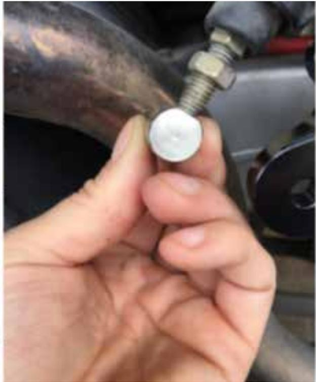
**5.** *Montare la pedana con il pedale del freno e fissare il tutto sulla piastra (mettere una rondella su entrambi i lati del cuscinetto, avendo cura di mettere il bordo arrotondato dal lato del cuscinetto). Montare il raccordo cilindro maestro / pedale e fissarlo con la rondella piccola e la clip.*
