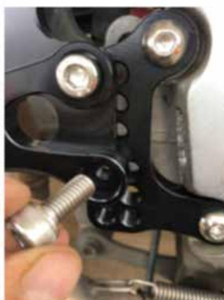
**4.** *Installa il nuovo pezzo di giunzione pedale cilindro maestro / freno (fai attenzione, c'è un lato piatto da mettere sul lato Cilindro maestro)*
