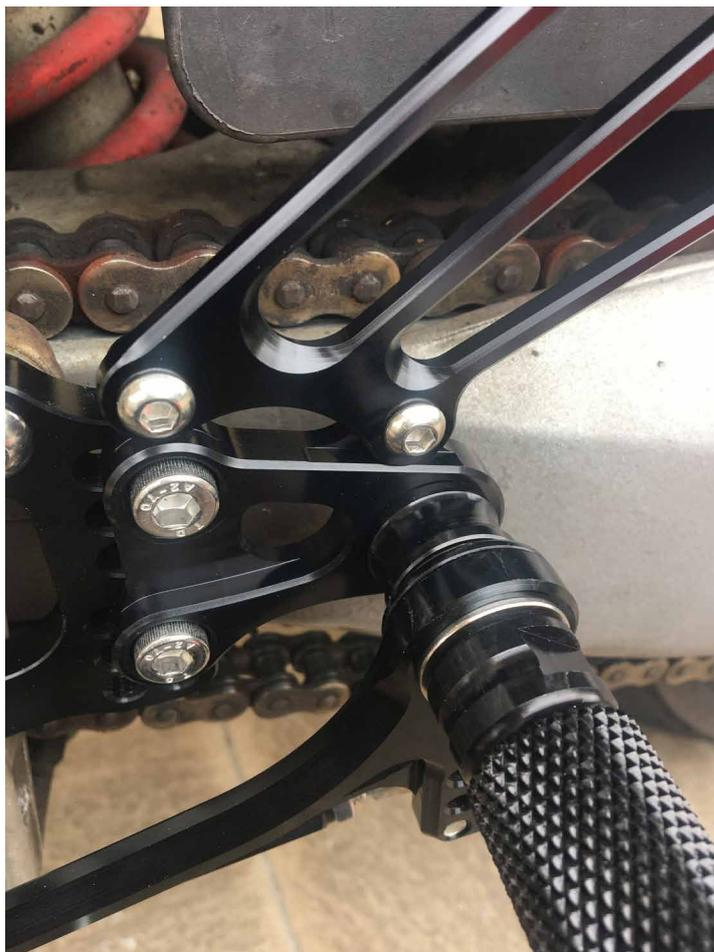
**6.** *Per il montaggio del cambio rovesciato (1a marcia in su), è sufficiente invertire la parte scanalata sull'albero del cambio e inserire l'asta più lunga.*
