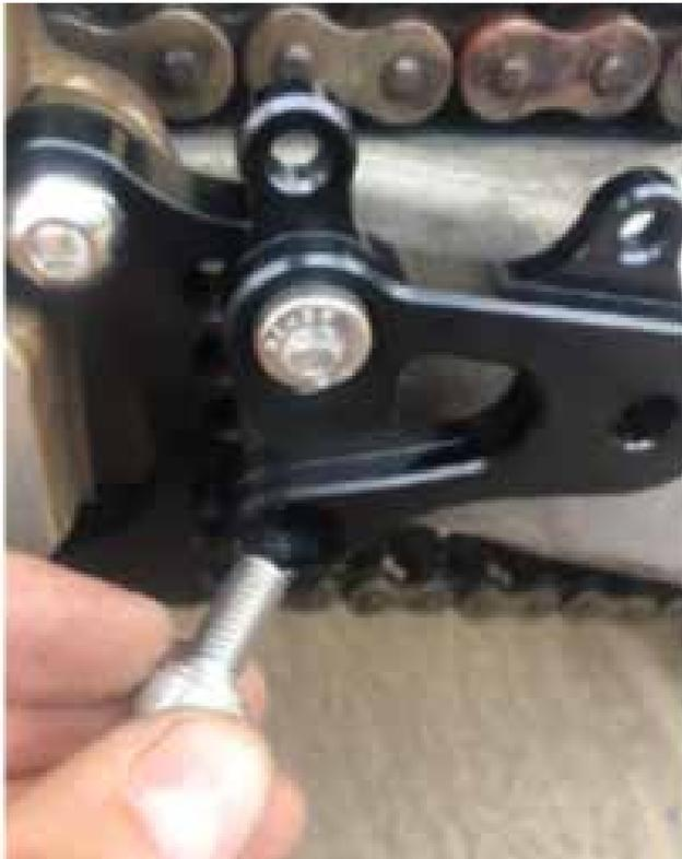
**3.** Montare la pedana con il cambio, come per il pedale del freno. Il distanziale sostituisce la 2a rondella (posizionarla sulla flangia piccola lato cuscinetto).
