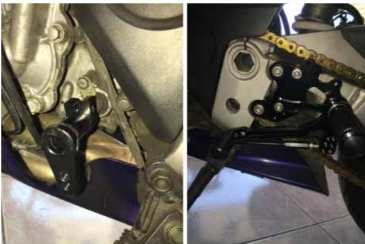
**4.** Fixer les nouvelles rotules à la tige de sélection en respectant les pas de vis puis fixer les rotules sur le sélecteur et sur le support biellette (pour la rotule arrière, utiliser l'entretoise)
