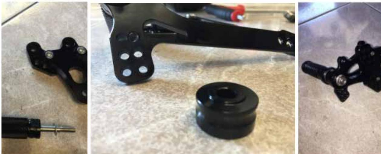
**3.** *Installer le nouveau support biellette sur l'axe de sélection. Puis fixer la nouvelle platine au cadre à l'aide des vis d'origine*
