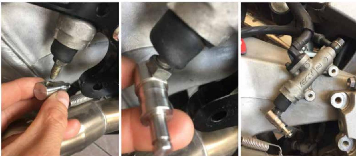
**4.** Assembler le repose-pied avec la pédale et la nouvelle platine. (Attention le côté arrondi des rondelles doit se placer côté roulement)
