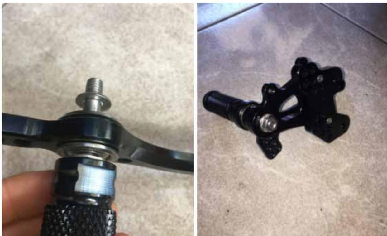
**5.** Fixer la nouvelle platine au cadre à l'aide des vis d'origine. Fixer l'ensemble MC et protège-talon à la platine à l'aide des vis fournies. Puis fixer le Maître-Cylindre à la pédale à l'aide de la rondelle et du clip
