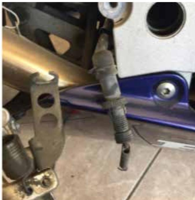
**3.** Schrauben Sie das neue MC-Verbindungsstück mit dem neuen Pedal
