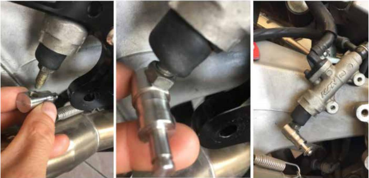
**4.** Montieren Sie die Fußstütze mit dem Pedal an der neuen Fußplatte.
