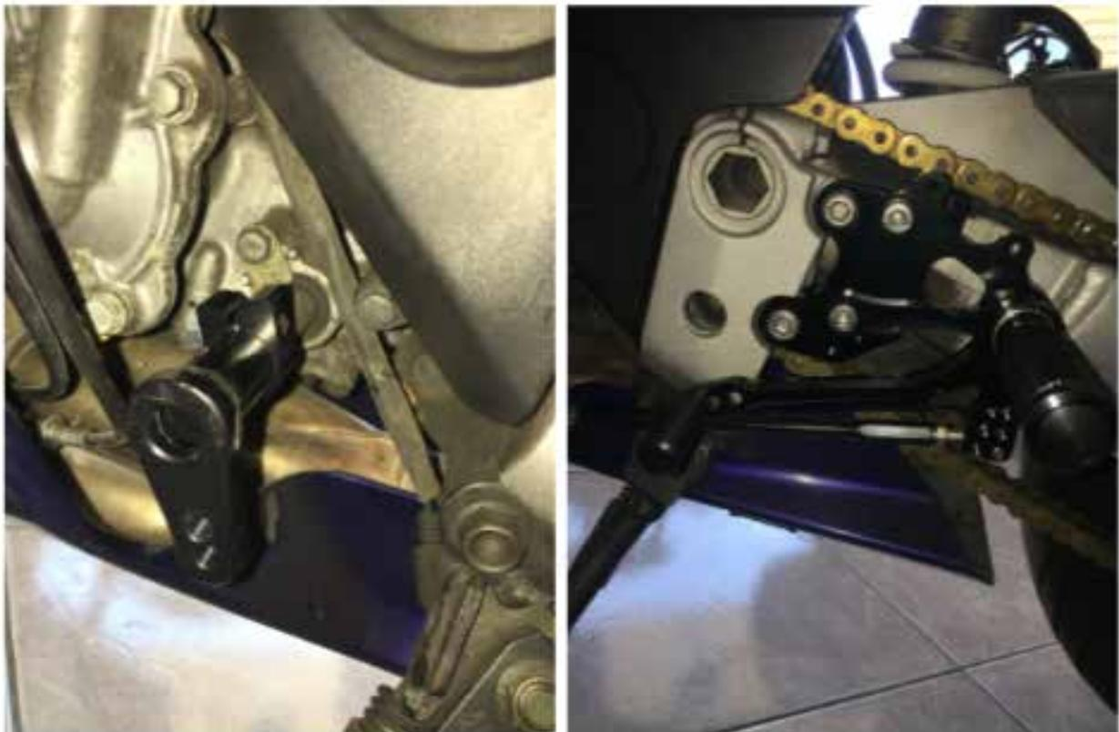
**4.** Befestigen Sie die neuen Kugelgelenke entsprechend den Schraubgewinden an der Schaltstange, dann befestigen Sie die Kugelgelenke an der Schaltstange und an der Gestängehalterung (für das hintere Kugelgelenk verwenden Sie das Distanzstück).
