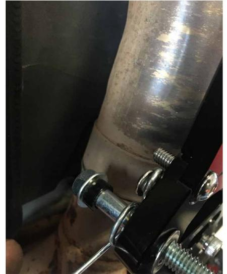
**6.** Instalar el reposapiés teniendo cuidado de poner la arandela cónica negro entre el reposapiés y el rodamiento. Instalar la tapa del pedal y el interruptor del freno en su posición prevista.
