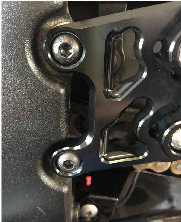
**3.** Desenroscar el tornillo que fija la manguera del líquido refrigerante en acero y la que fija el cárter del piñón del cambio. Luego, fijar el soporte del pivote con los tornillos suministrados (OJO: el collar que sostiene el cable del contactor de la muleta debe permanecer entre el soporte y el cárter de PS). Fijar el pivote con el alargador y el tornillo allen suministrado.
