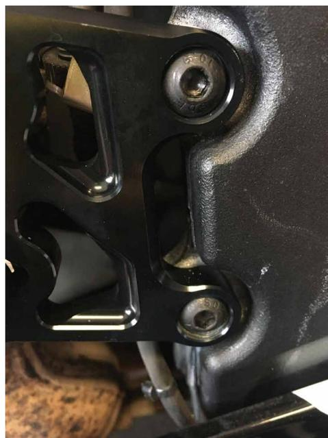
**5.** Volver a conectar el cilindro maestro con los 2 tornillos allen suministrados para la parte superior y el eje y el clip en la parte de la rótula. (Colocar bien el muelle que permite el retorno del pedal del freno). Al instalar el pedal de freno, asegúrese de que la arandela entre la platina y el rodamiento está bien colocada, es decir, el borde redondeado del lado del rodamiento.
