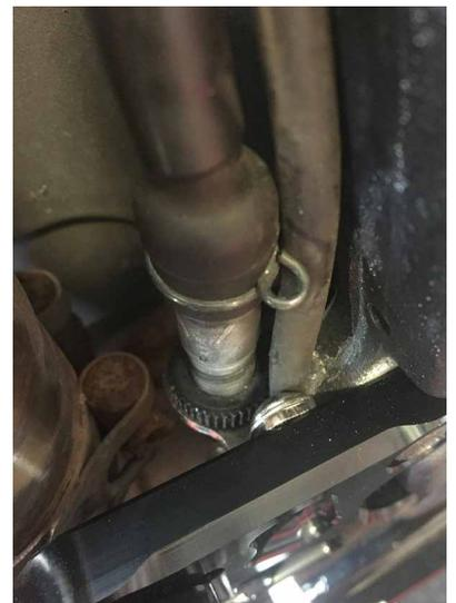
**Es obligatorio fijar la manguera del depósito de freno a la manguera del freno que sale del Cilindro Maestro utilizando el collar de nilón para que la manguera no entre en contacto con el tubo de escape.**
