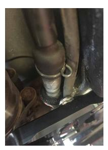
Es ist unbedingt erforderlich, den Schlauch des Bremsgefäßes mit der Nylonmanschette am Bremsschlauch vom Hauptzylinder zu befestigen, damit der Schlauch nicht mit dem Auspuffrohr in Berührung kommt.
