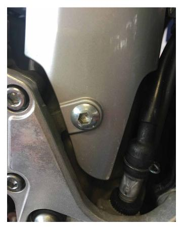
3. Die Platte durch Lösen der 2 BTR-Schrauben vom Rohmen entfernen.
