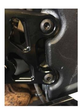
**5.** Befestigen Sie den Hauptzylinder mit den 2 BTR-Schrauben, die für den oberen Teil vorgesehen sind. und der Stift und der Clip auf dem Kugelteil (Positionieren Sie die Feder so, dass das Bremspedal zurückkehren kann). Beim Einbau des Bremspedals ist darauf zu achten, dass die Unterlegscheibe zwischen der Platte und dem Lager richtig positioniert ist, d.h. die abgerundete Kante auf der Lagerseite.
