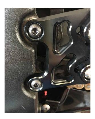
3. Lösen Sie die Schraube, mit der der Stahl-Kühlmittelschlauch befestigt ist, und die Schraube, mit der die Abdeckung des Getriebeausgangsritzels befestigt ist, und befestigen Sie dann die Schwenkhalterung mit den mitgelieferten Schrauben (beachten Sie, dass die Manschette, die das Standschalterkabel hält, zwischen der Halterung und dem Getriebeausgangsritzels verbleiben muss). Befestigen Sie den Schwenkhalterung mit dem langen Distanzstück und der mitgelieferten BTR-Schraube.
