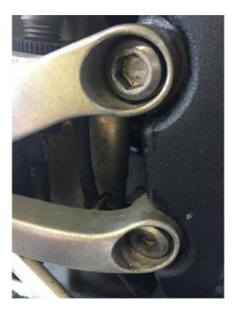
2. Entfernen Sie die Platte vom hinteren Hauptbremszylinder, indem Sie die Schraube und Mutter abschrauben, die das Pedal am Hauptzylinder hält, (Vorsicht, es gibt einen Splint), die 2 BTR-Schrauben, die den Fersenschutz halten, und die Befestigungsschraube des Aluminiumschutzes lösen. (2 BTR-Schrauben)
