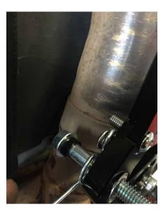
**5.** Installieren Sie die Fußstütze, wobei darauf zu achten ist, dass die schwarze konische Unterlegscheibe zwischen Fußstütze und Lager platziert wird. Installieren Sie die Pedalspitze und den Bremsschalter an der vorgesehenen Stelle.
