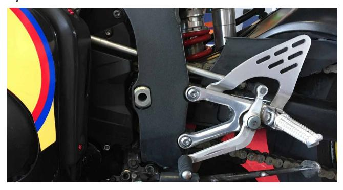
E 'possibile passare al cambio rovesciato (1 marcia in su) ruotando il leveraggio di 180 ° sull'albero del cambio, ma sarà necessario prevedere di distanziare il vaso di espansione.
