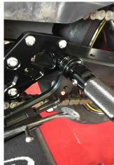
4. Rimuovere il giunto sferico originale sul collegamento albero cambio e ricollegare sull'altro lato.
