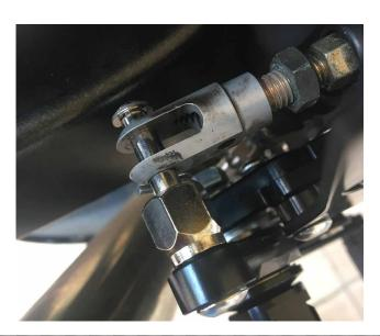
**4.** Installare la molla e l'interruttore del freno (Utilizzare la molla fornita per il contattore, se necessario, e regolarla alla lunghezza giusta in base alle necessità).
