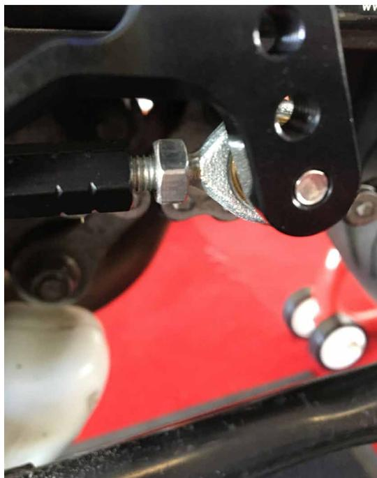
**8.** Installa la protezione per il tallone utilizzando le piccole viti a brugola fornite
