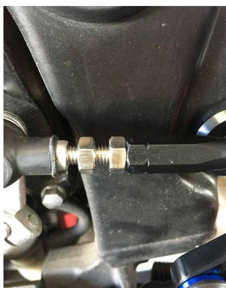
**7.** Fissare il giunto sferico dell'asta del cambio sul cambio
