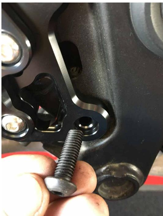
**4.** Rimuovere il serbatoio del freno posteriore per spostarlo successivamente
