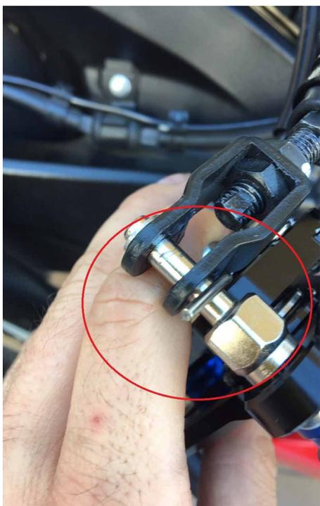
**3.** Volver a acoplar el cilindro maestro a la platina, la platina del chasis, y el protector del talón con ayuda de las tuercas.
