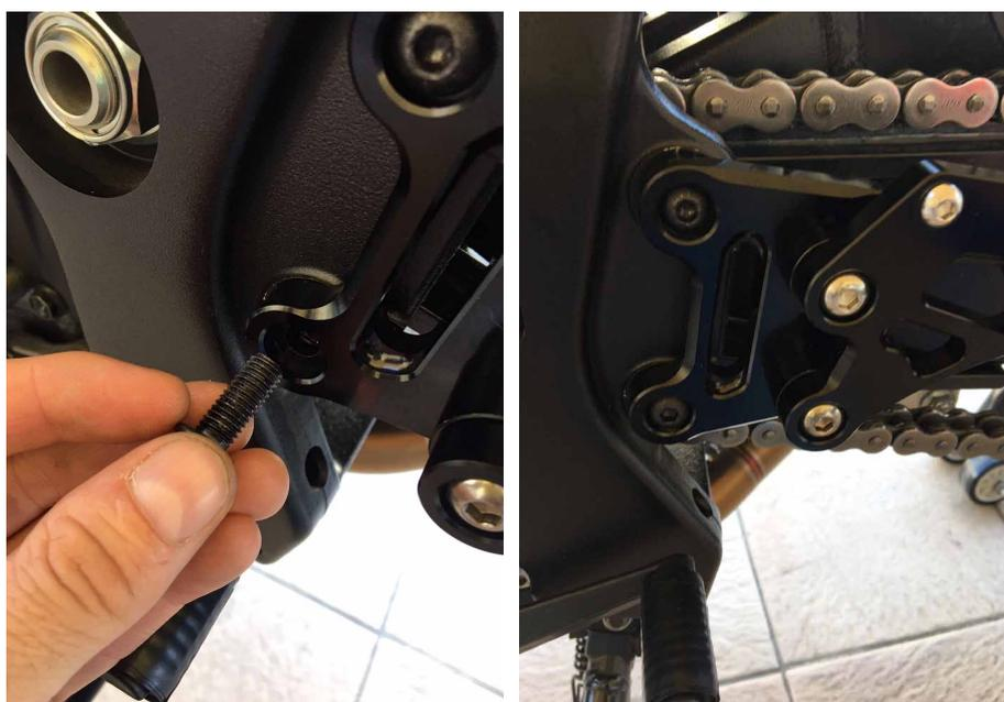
**3.** Fijar el nuevo selector en lugar del original utilizando el tornillo grande BTR y el separador grande (poner el borde del separador del lado de rodadura)
