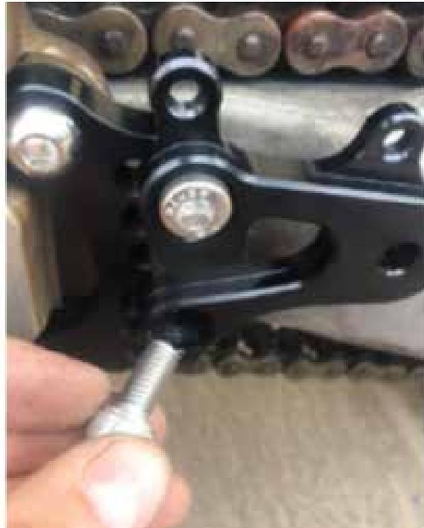
**3.** Montieren Sie die Fußstütze mit dem Schalthebel in der gleichen Weise wie das Bremspedal. Der Abstandhalter ersetzt die 2. Unterlegscheibe (positionieren Sie sie mit einem kleinen Flansch auf der Lagerseite).
