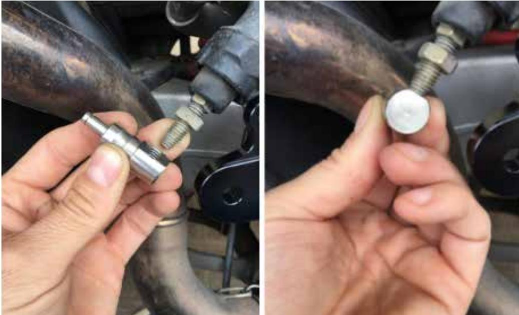
**5.** Montieren Sie die Fußstütze mit dem Bremspedal und befestigen Sie das Ganze auf der Platte (legen Sie eine Unterlegscheibe auf jede Seite des Lagers, wobei darauf zu achten ist, dass die abgerundete Kante auf die Lagerseite gelegt wird). Setzen Sie das Verbindungsstück MC/Pedal ein und sichern Sie es mit der kleinen Unterlegscheibe und dem Clip.
