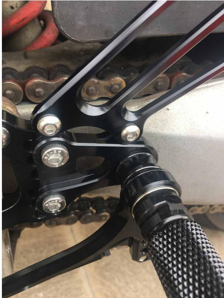
**6.** Für den Zusammenbau in umgekehrter Reihenfolge (1. oben) einfach den verzahnten Teil auf der Schaltwelle umdrehen und die längere Stange einsetzen.
