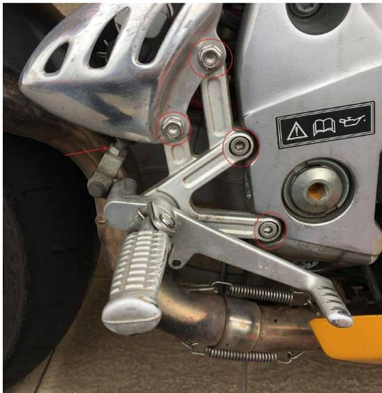
**2.** Schrauben Sie das Verbindungsstück zwischen dem Pedal und dem MC ab. (Der Clip muss nicht entfernt werden, es gibt eine unverlierbare Mutter, so dass es ausreicht, die komplette Platte zu drehen)
