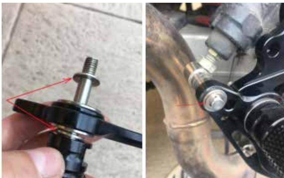
**6.** Befestigen Sie den MC gleichzeitig mit dem Fersenschutz mit den mitgelieferten Schrauben wieder (denken Sie daran, den ursprünglichen Abstandshalter zwischen Platte und MC für die Unterseite und den Bremsschalterträger für die Oberseite anzubringen).
