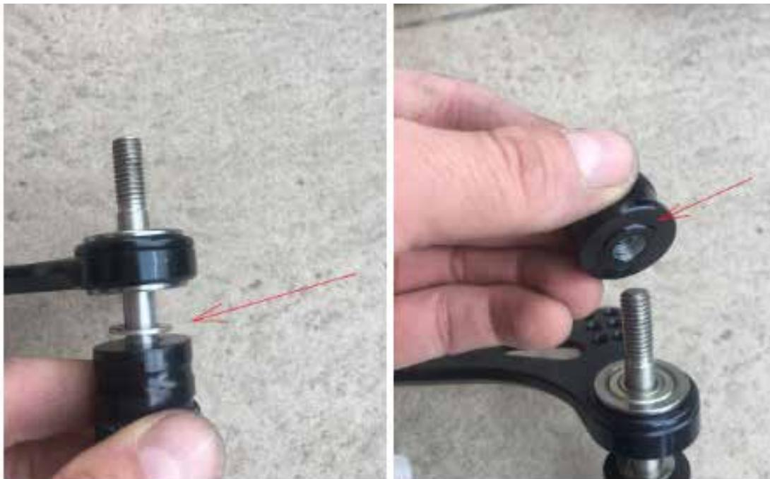
**4.** Nach dem Befestigen des verzahnten Teils auf der Schaltwelle befestigen Sie die Schaltstange (kurz) Verwenden Sie auf der Schalterseite das mitgelieferte Distanzstück
