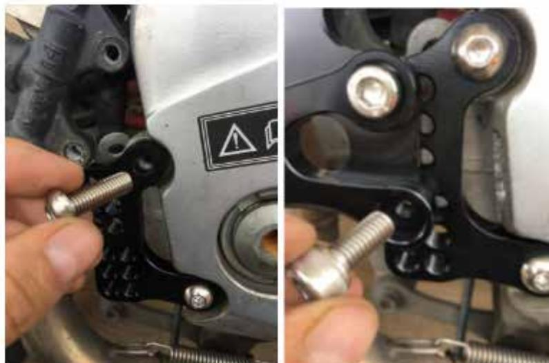
**4.** Installieren Sie das neue MC-Verbindungsstück/Bremspedal (Achtung, auf der MC-Seite ist eine flache Seite zum Aufsetzen vorhanden)
