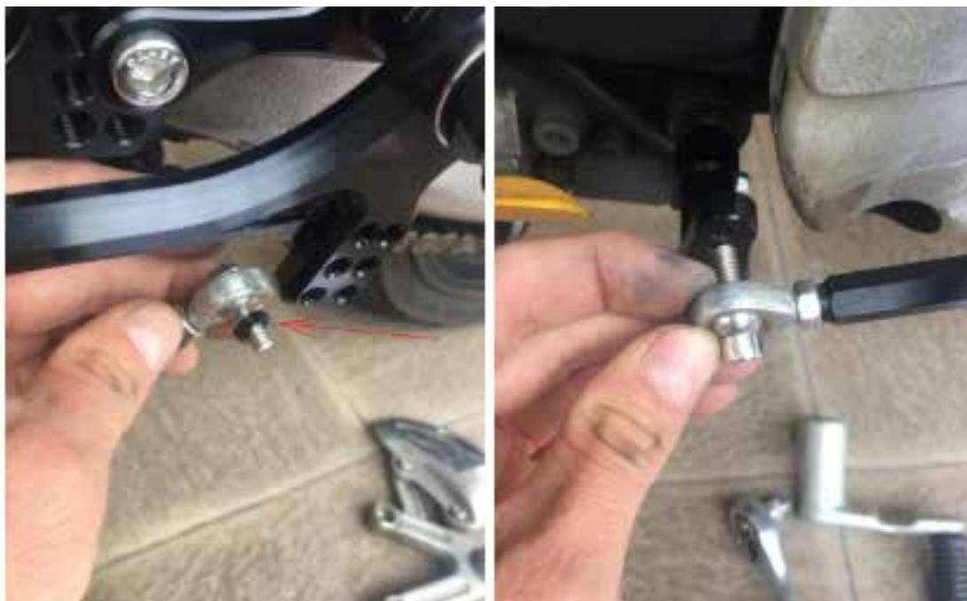
**5.** Installieren Sie den Fersenschutz mit den mitgelieferten kleinen Schrauben.
