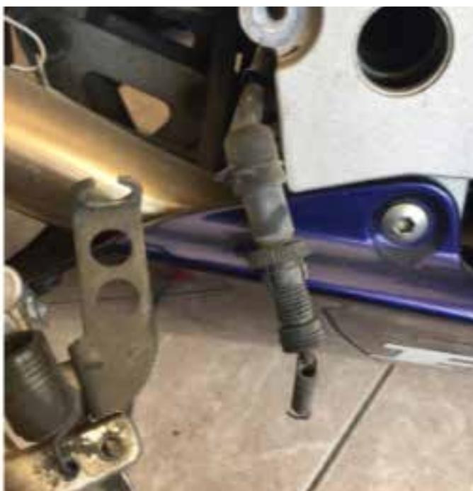
**3. Atornillar la nueva pieza de unión del Maestro-Cilindro con el nuevo pedal**
