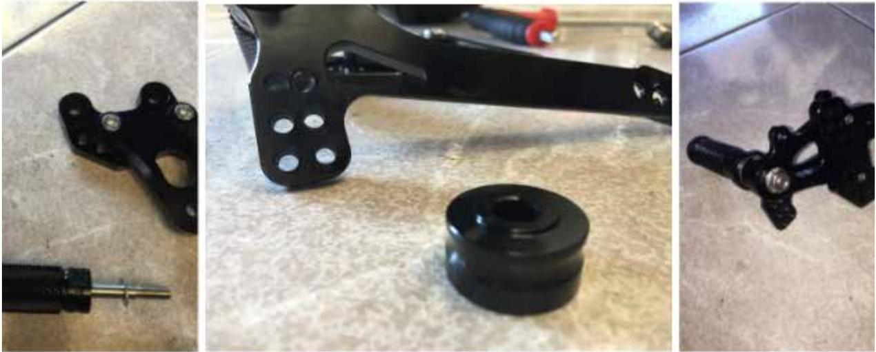
**3.** Instalar el nuevo soporte de biela en el eje de selección. A continuación, fijar la nueva estribera al cuadro con los tornillos originales
