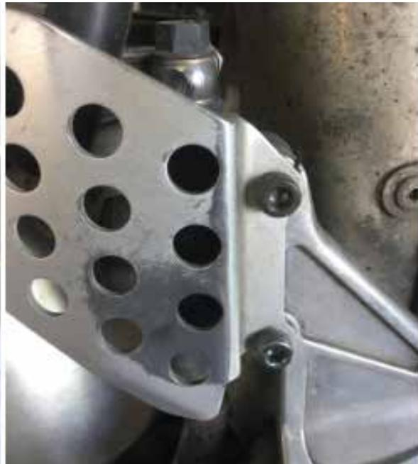
**3.** Die kleine Platte von hinten mit den mitgelieferten Schrauben befestigen. Und befestigen Sie die Hauptplatte mit den Originalschrauben am Rahmen.
