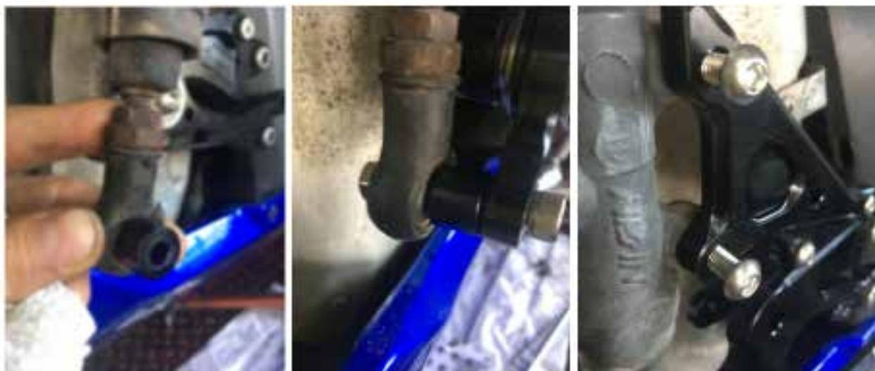
**5.** *Befestigen Sie die Fußstütze und die Bremspedalspitze.*
