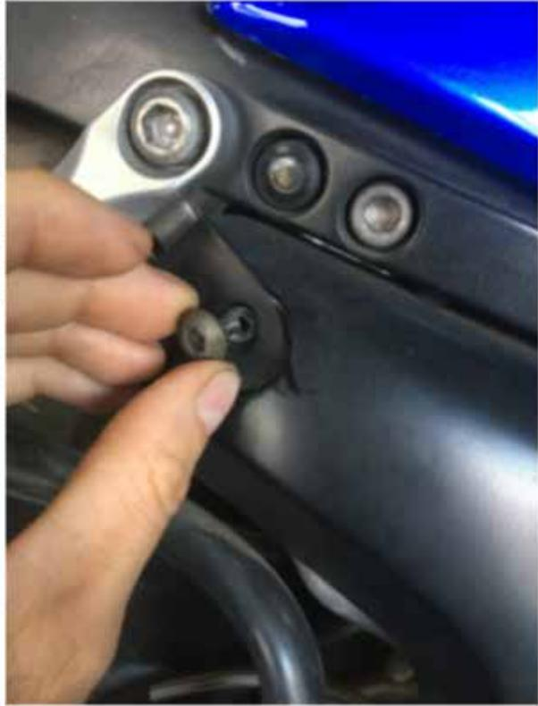
**2.** Entfernen Sie die Befestigungsschrauben des Hauptzylinders. Und demontieren Sie die Platte durch Lösen der Schrauben, mit denen sie am Rahmen befestigt ist.
