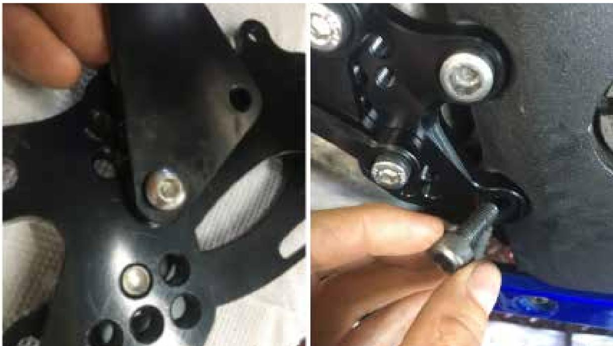
**4.** Installieren Sie das mitgelieferte Distanzstück in das MC-Kugelgelenk (Vorsicht, mit der Zeit kann sich Oxidation in der Öse bilden und die Installation des Distanzstücks etwas erschweren). Befestigen Sie den MC mit den mitgelieferten Schrauben am Bremspedal und an der Platte.
