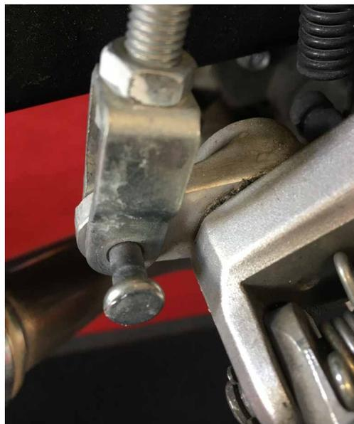
**2.** Separar el cilindro maestro de la platina y desmontar la platina del chasis
