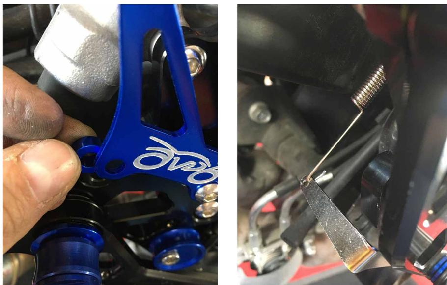
**8.** Fijar el depósito con ayuda de la pata de aluminio suministrada, que tendrá que formar en función de la ubicación elegida (aquí el tornillo de fijación del soporte del regular). Usted tendrá que girar la manguera (no desmontar!)
