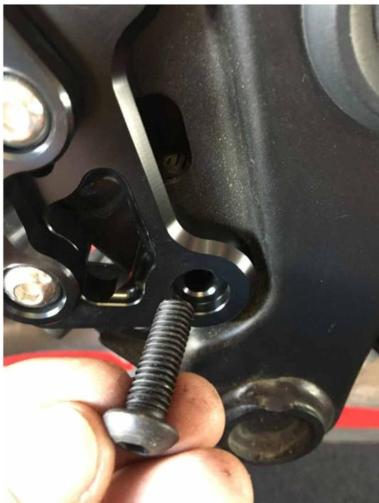
**4.** Desmontar el depósito de freno trasero para desplazarlo luego.
